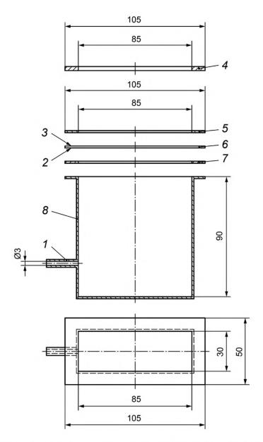
1 — штуцер для создания отрицательного давления и измерения перепада давления; 2 — внутренняя поверхность испытуемой пробы; 3 — внешняя поверхность испытуемой пробы; 4 — прямоугольный зажим (например, из нержавеющей стали); 5 — прямоугольная прокладка; 6 — испытуемая проба; 7 — прямоугольная прокладка; 8 — прямоугольная герметичная емкость (например, из нержавеющей стали)
