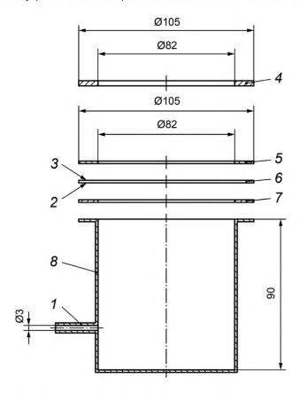
1 — штуцер для создания отрицательного давления и измерения перепада давления; 2 — внутренняя поверхность испытуемой пробы; 3 — внешняя поверхность испытуемой пробы; 4 — зажимное кольцо (например, из нержавеющей стали); 5 — уплотнительное кольцо; 6 — испытуемая проба; 7 — уплотнительное кольцо; 8 — цилиндрическая герметичная емкость (например, из нержавеющей стали)
