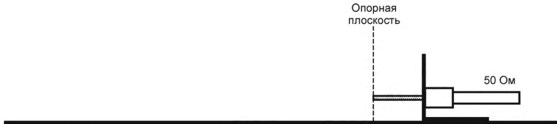
Рисунок 27b — Конфигурация при калибровочном измерении «отражение, порт B»
