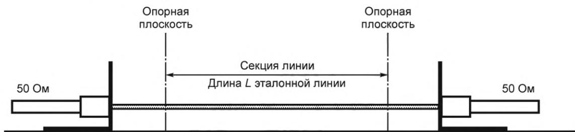
Рисунок 27d — Конфигурация при калибровочном измерении «линия»
