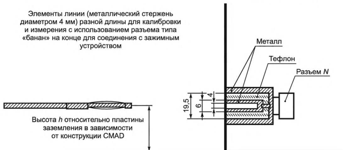
Примечание — Нижние части вертикального фланца имеют электрическое соединение с металлической пластиной заземления.
