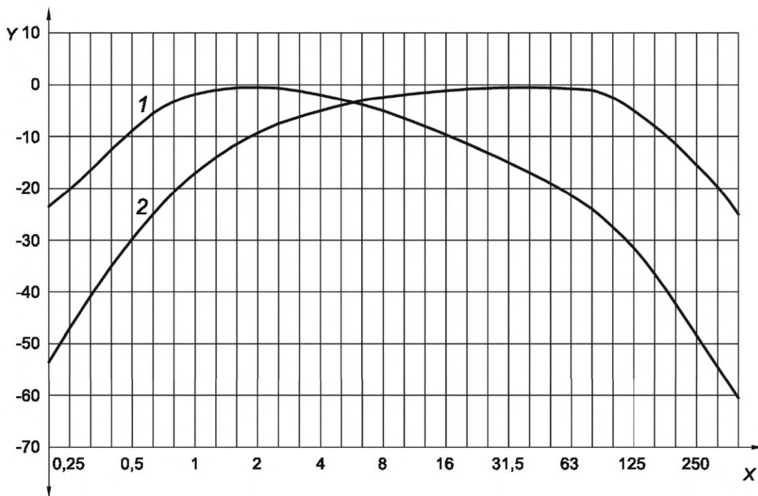
X — частота, Гц; Y — модуль функции частотной коррекции, дБ; 1 — функция частотной коррекции для ускорения  $W_a$ ; 2 — функция частотной коррекции для скорости  $W_v$
