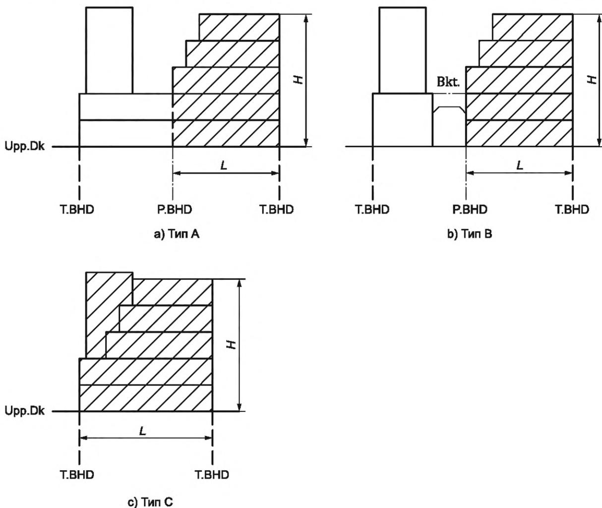
Upp.Dk — верхняя палуба; Т.ВНД — поперечная переборка; Р.ВНД — неполная поперечная переборка или шпангоут;
