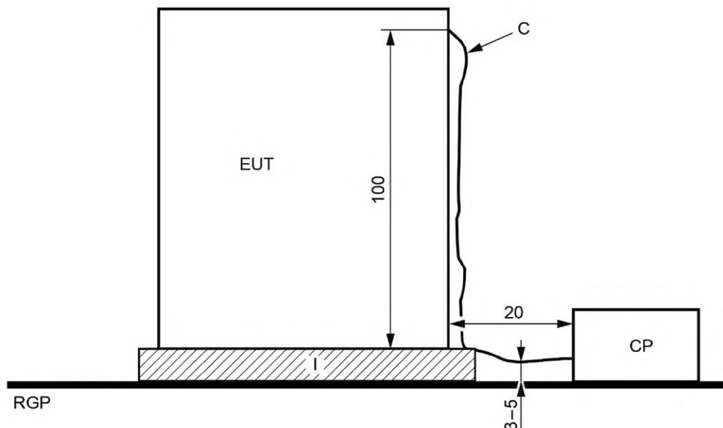
RGP — опорная пластина заземления; I — подставка из изолирующего материала;
