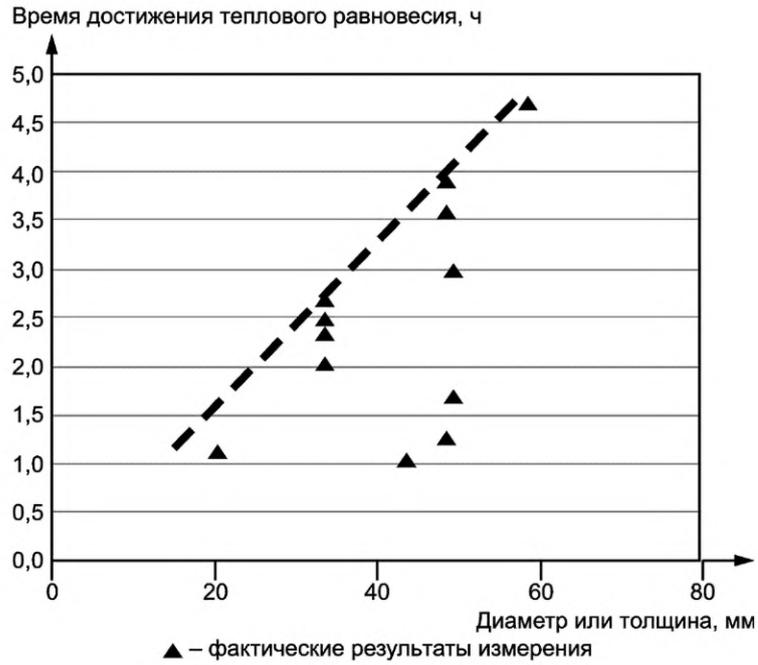
Рисунок С.2 — Длительность достижения теплового равновесия конденсаторов (от минус 40 °С до плюс 25 °С)
