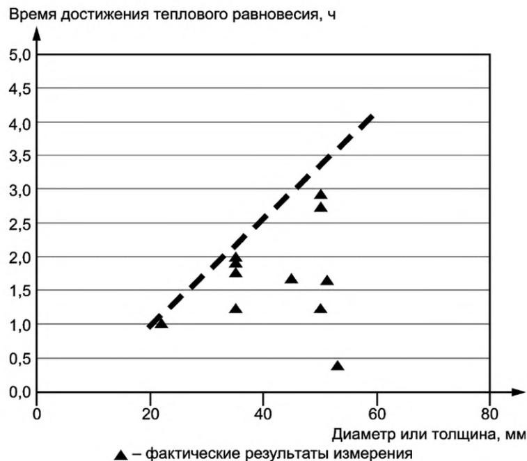
Рисунок С.1 — Длительность достижения теплового равновесия конденсаторов (от 85 °С до 25 °С)
