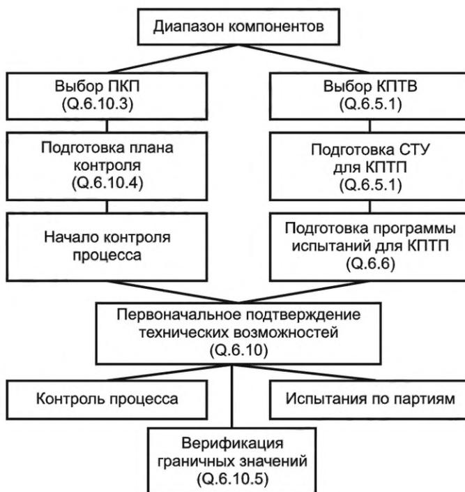
Рисунок Q.1 — Общая схема подтверждения технических возможностей
