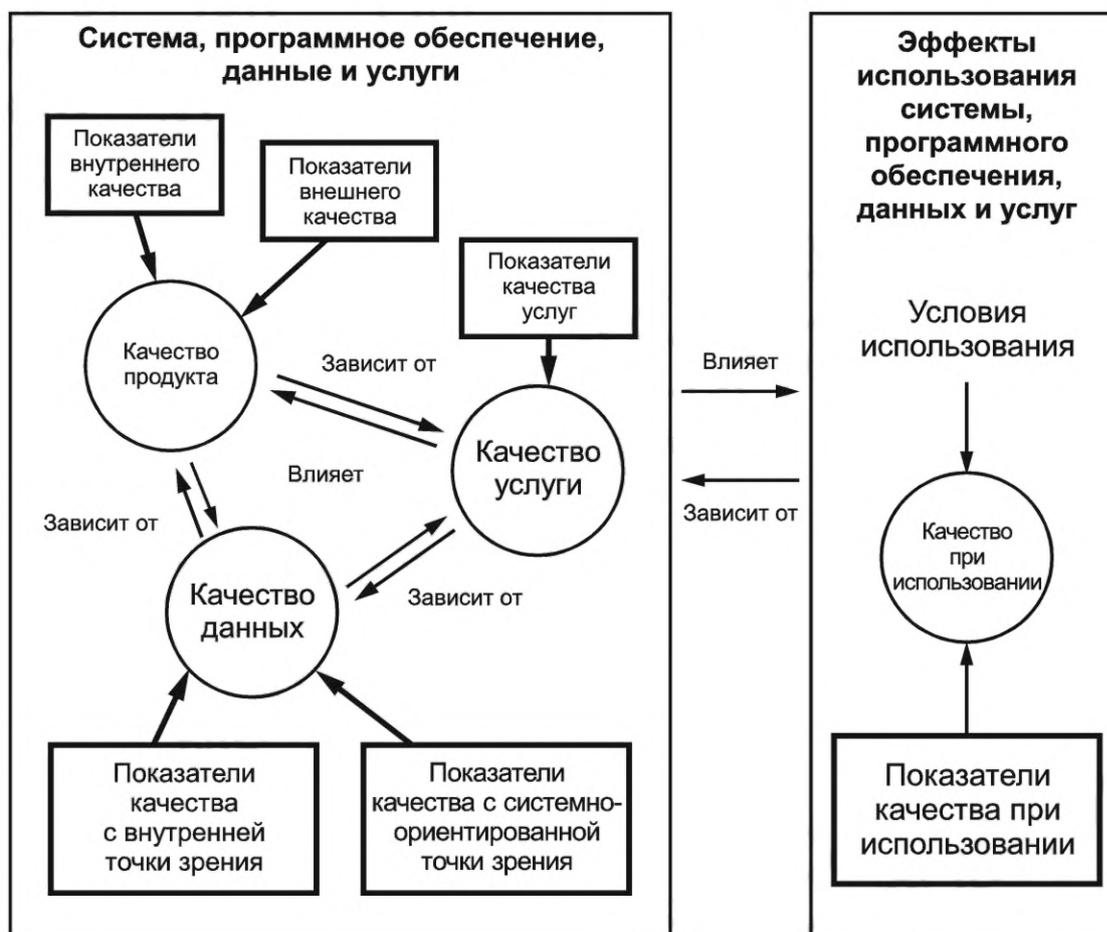
Рисунок 2 — Взаимосвязь между различными моделями качества из серии SQuaRE
