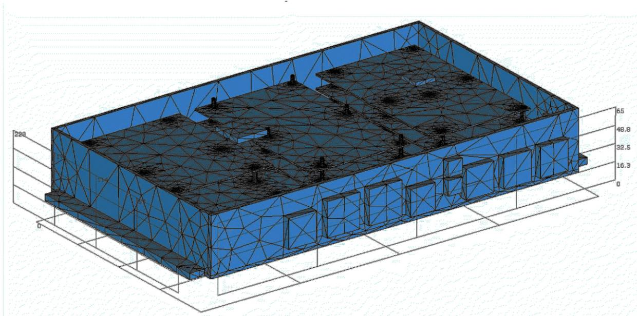
Рисунок А.6 — Автоматическое разбиение на конечные элементы
