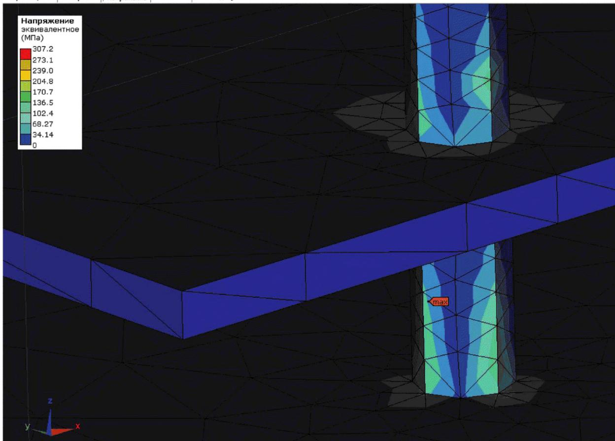
Рисунок А.8 — Среднеквадратические эквивалентные механические напряжения во всех точках конструкции блока ЭА
