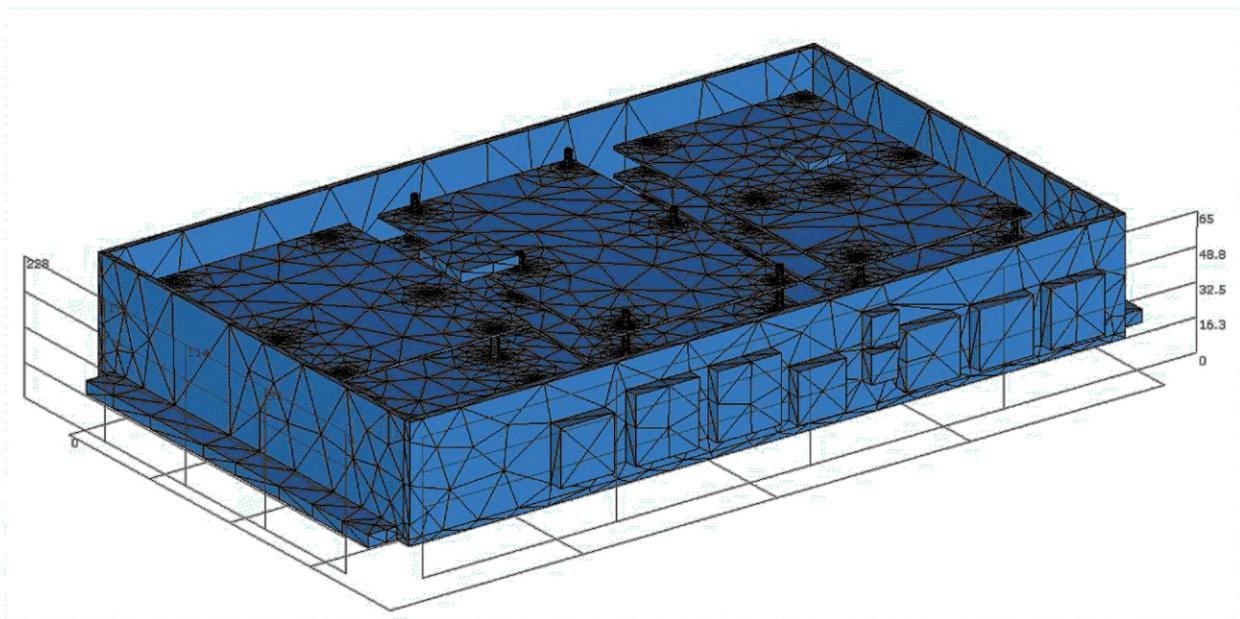
Рисунок А.2 — Автоматическое разбиение на конечные элементы
