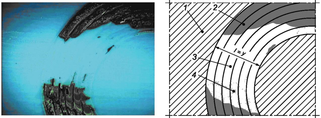
1 — поверхность трубы; 2 — пластическое разрушение; 3 — хрупкое разрушение без адгезии с поверхностью сплавления; 4 — хрупкое разрушение между витками закладного нагревателя;  $l$  — максимальная длина хрупкого разрушения;  $y$  — общая длина зоны сплавления
