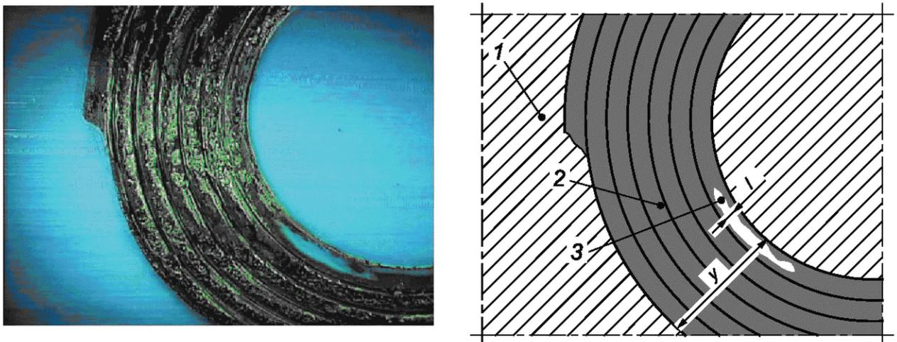
1 — поверхность трубы; 2 — пластическое разрушение; 3 — хрупкое разрушение между витками закладного нагревателя;  $l$  — максимальная длина хрупкого разрушения;  $y$  — общая длина зоны сплавления
