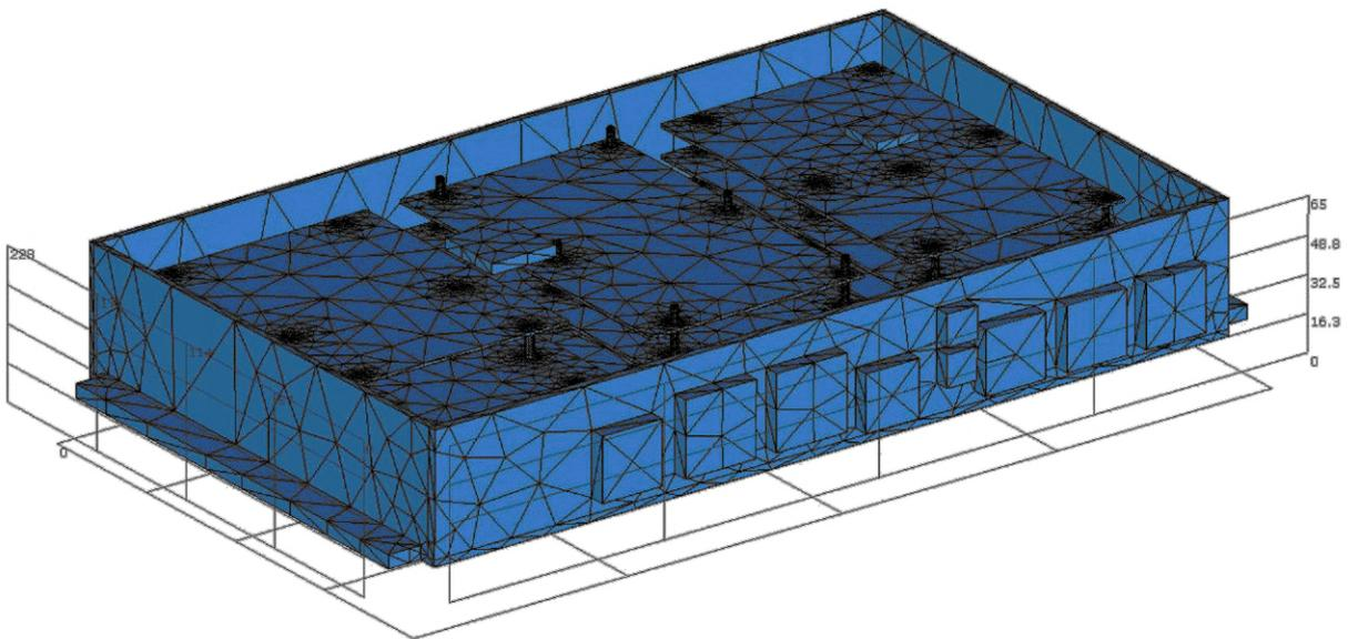
Рисунок А.5 — Автоматическое разбиение на конечные элементы
