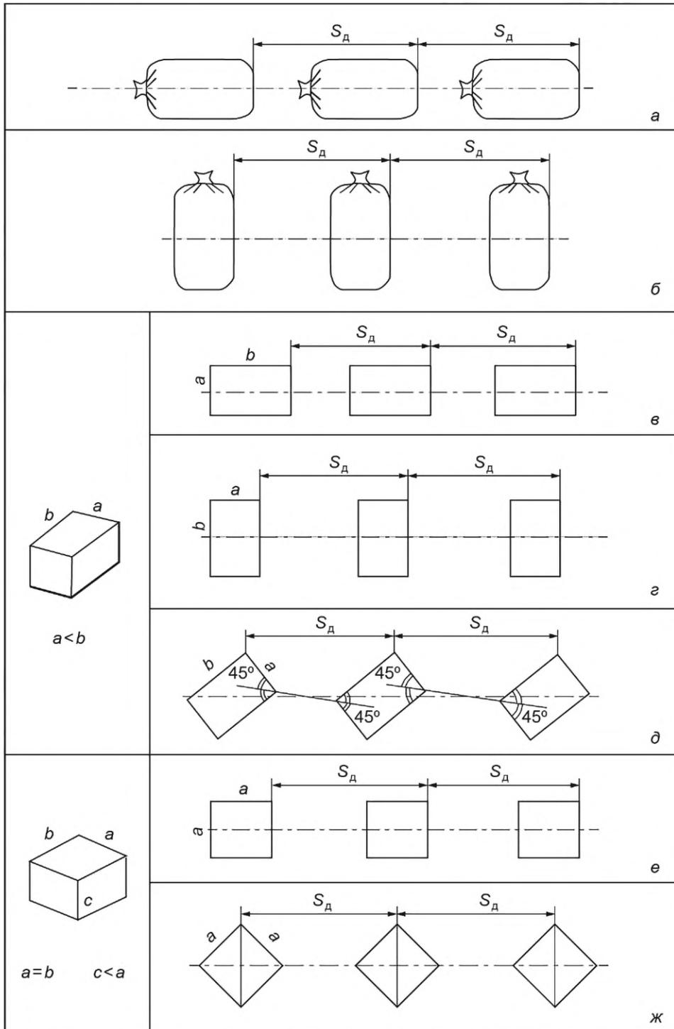
Рисунок 1 — Схема взаимной ориентации мешков (а, б) и ящиков (в—ж) с ВВ на конвейерах
