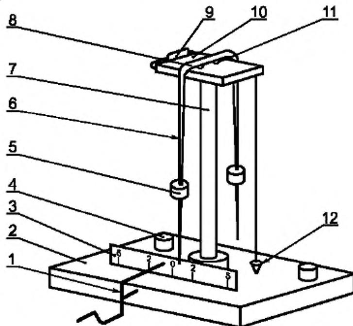
1 — пусковой механизм; 2 — основание; 3 — шкала; 4 — установочные винты;
