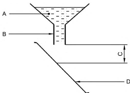
A — 50 мл воды при температуре  $(20 \pm 3) \text{ }^\circ\text{C}$ ; B — внутренний диаметр 2 мм; C — расстояние в диапазоне от 20 до 50 мм; D — смотровое окно
