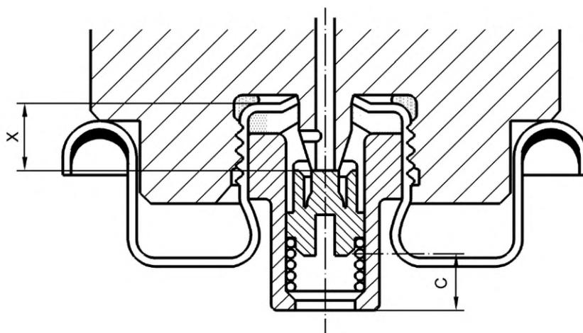
b) соответствующие размеры открытия клапана переходником — клапан полностью открыт
