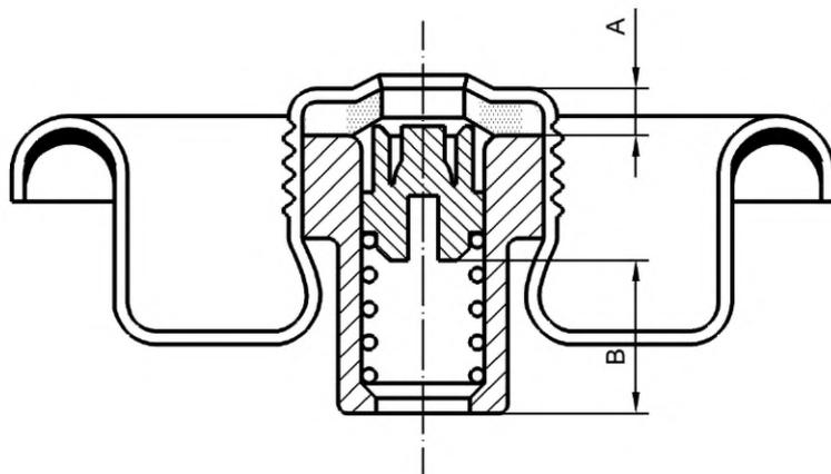
a) соответствующие размеры открытия клапана переходником — клапан полностью закрыт
