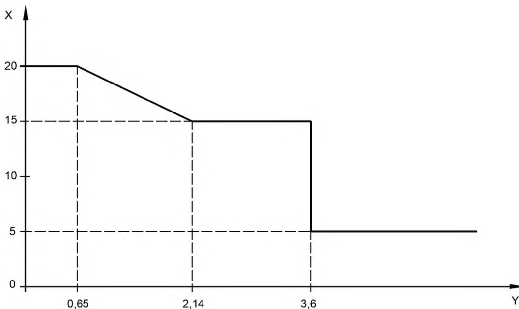
X — допустимое отклонение, %; Y — номинальный расход горелки, кВт
