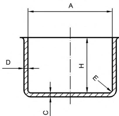
А — внутренний диаметр, измеренный по верхнему краю, мм; Н — внутренняя высота, мм; С — толщина дна, мм; D — толщина стенок, мм; Е — внутренний радиус скругления, мм
