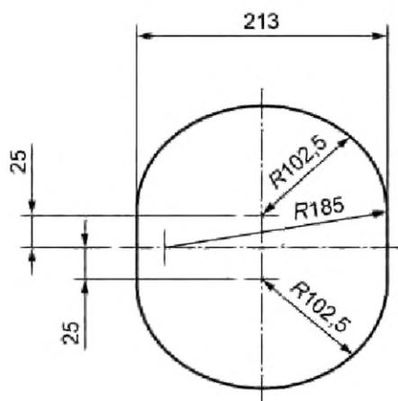
Рисунок 2 — Размеры отверстия в основании термокамеры
