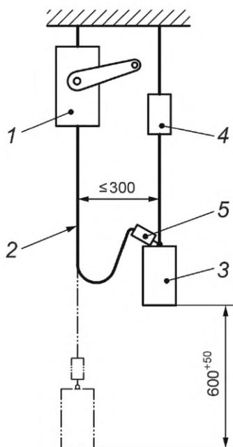
1 — спасательное подъемное устройство; 2 — строп;
