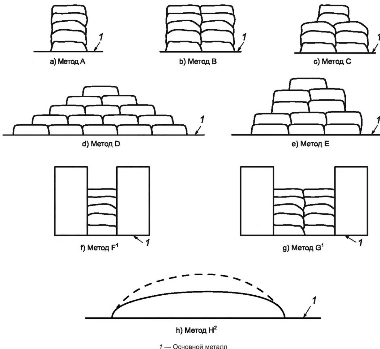
Примечание 1 — Блоки по обеим сторонам от наплавленного металла для методов F и G изготовлены из меди.
