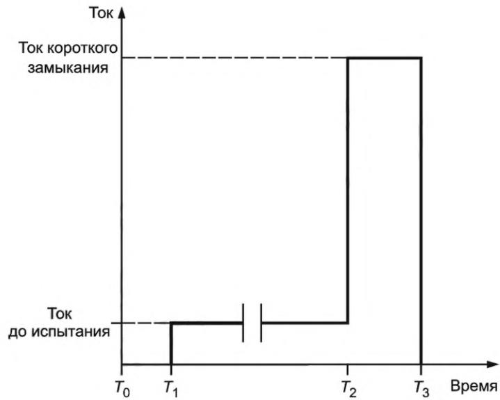
$T_0$  — размыкание короткозамыкающего переключателя (см. 9.3.4.1.6 а);  $T_1$  — испытательная цепь под напряжением (см. 9.3.4.1.6 б);  $T_2$  — замыкание короткозамыкающего переключателя (9.3.4.1.6 с);  $T_3$  — УЗКЗ отключает короткое замыкание
