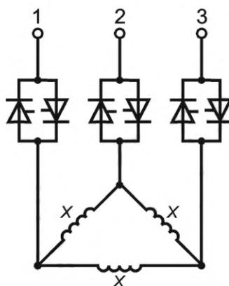
2c) Двигатель с подключением по схеме «треугольник» — тиристоры, подключенные между обмоткой и источником питания
