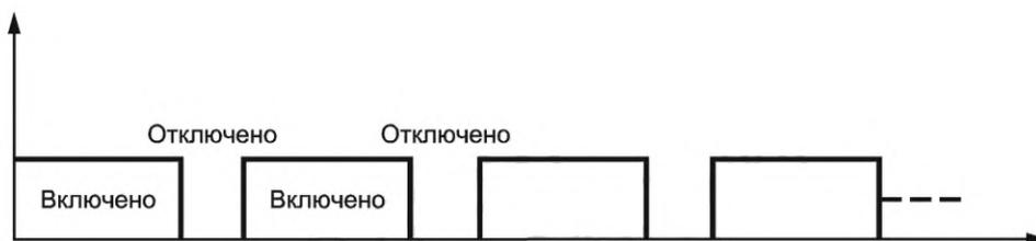
Характерный профиль под нагрузкой/без нагрузки
