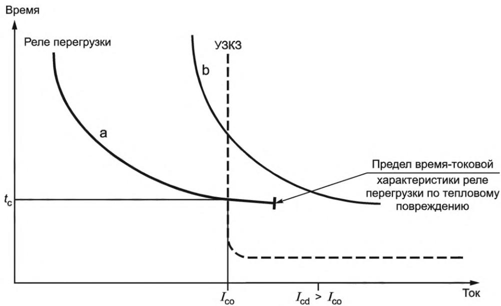
a — средняя время-токовая характеристика реле перегрузки из холодного состояния;
