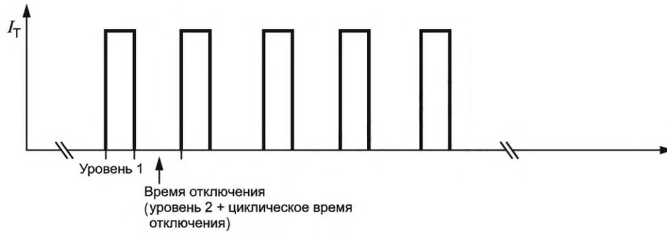
Характерный профиль испытательного тока AC-2а, AC-3а, AC-8а
