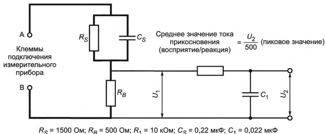
Примечание — Испытательная измерительная цепь приведена по IEC 60990:2016 (рисунок 4).
