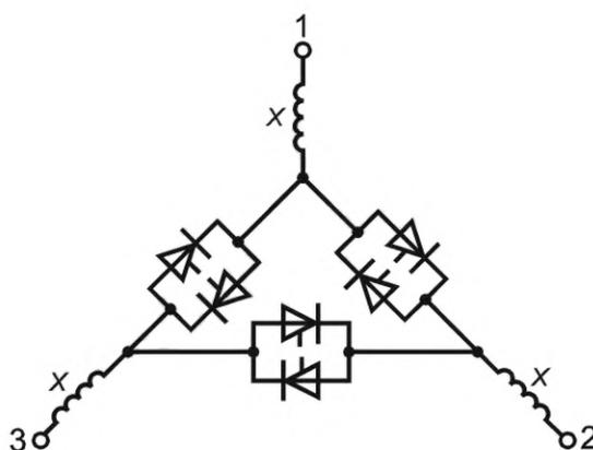
2b) Двигатель с подключением по схеме «звезда» — тиристоры, подключенные по схеме «треугольник»
