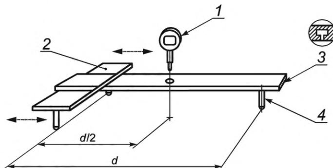
1 — индикатор часового типа; 2 — регулируемый мост; 3 — Т-образный паз; 4 — регулируемая опора;
