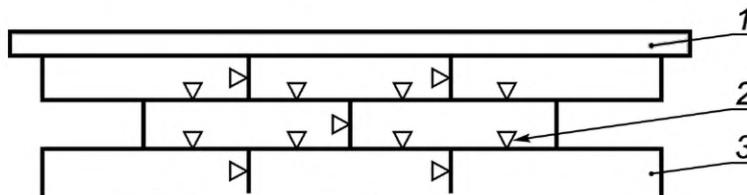
1 — стальная линейка; 2 — точка измерения ( $\nabla$ ); 3 — образец
