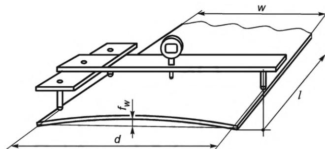
$d$  — расчетная длина образца для испытаний;  $l$  — длина образца для испытаний;  $w$  — ширина образца для испытаний;
