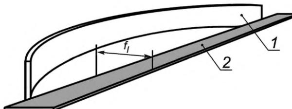
1 — образец для испытаний; 2 — стальная линейка;  $f_l$  — плоскостность по длине
