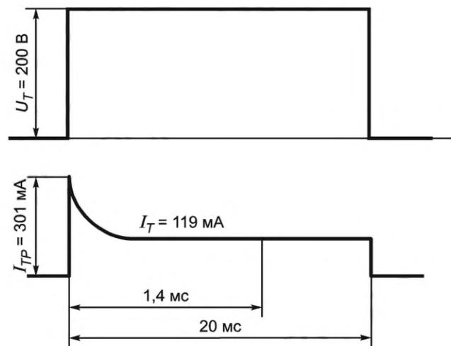
Примечание — При  $U_T = 200 \text{ В}$  постоянного тока, длительности протекания тока 20 мс, токе прикосновения  $I_T = 129 \text{ мА}$  (действующее значение), амплитудном значении тока прикосновения  $I_T = 301 \text{ мА}$ , общем полном сопротивлении тела  $Z_T = 1681 \text{ Ом}$ , начальном активном сопротивлении тела  $R_0 = 664 \text{ Ом}$  возникает сильное ощущение жжения и непроизвольные мускульные реакции подергивания в руках и плечах.
