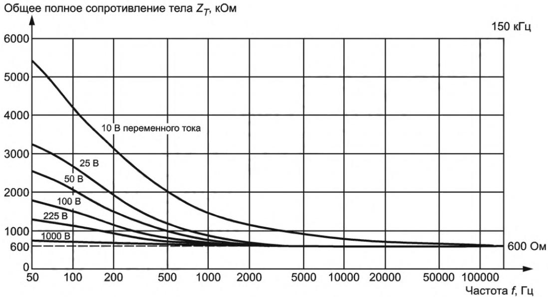
Рисунок А.12 — Зависимость от частоты для общего полного сопротивления  $Z_T$  при протекании тока между кистями рук или от кисти руки до ступни ноги при большой площади контакта с электрической цепью в сухих условиях при напряжениях прикосновения в диапазоне от 10 до 1000 В переменного напряжения частотой от 50 Гц до 150 кГц для процентильного ранга населения, равного 50 %
