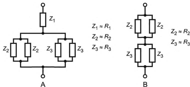
Рисунок Е.2 — Схемы замещения для животного при протекании тока от носа до четырех конечностей (путь А) и от передних конечностей к задним (путь В)
