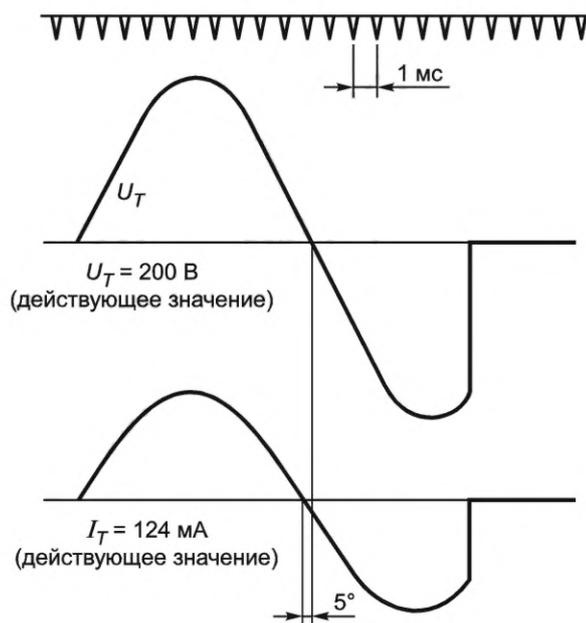
Примечание — При  $U_T = 200$  В переменного тока (действующее значение), длительности протекания тока 16,5 мс,  $I_T = 124$  мА (действующее значение) на осциллограмме тока отсутствуют импульсы, общее полное сопротивление тела  $Z_T = 1613$  Ом, физиологические реакции аналогичны описанным на рисунке а).
