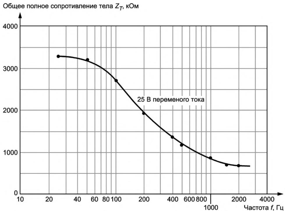
Рисунок А.11 — Значения общего полного сопротивления  $Z_T$  при протекании тока между кистями рук при большой площади контакта с электрической цепью в сухих условиях при напряжении прикосновения 25 В переменного напряжения частотой от 25 Гц до 2 кГц (измерения проведены на одном живом человеке)
