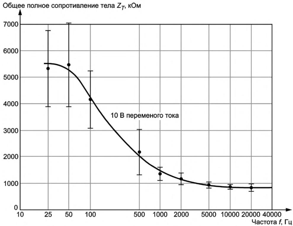
Рисунок А.10 — Значения общего полного сопротивления  $Z_T$ , измеренные у 10 живых людей, при протекании тока между кистями рук при большой площади контакта с электрической цепью в сухих условиях при напряжении прикосновения 10 В переменного напряжения частотой от 25 Гц до 20 кГц
