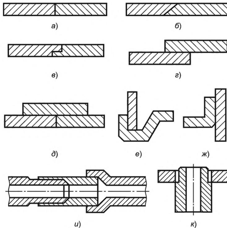
а) — соединение встык (прочность шва низкая); б) — соединение вскос (прочность шва выше, чем в случае а); в) — ступенчатое соединение (высокие требования к сборке и прочности шва); г) — соединение внахлест (прочность шва зависит от площади перекрытия); д) — соединение встык с накладкой (высокая прочность соединения); е) — соединение в замок; ж) — соединение втавр; и) — телескопическое соединение (высокие требования к сборке и прочности соединения); к) — соединение трубы с фланцем
