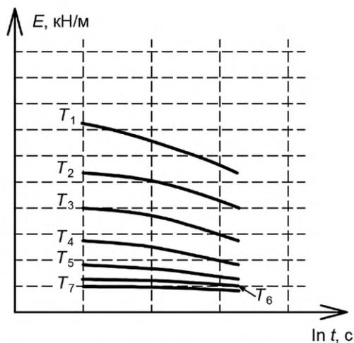
Рисунок Г.2 — Податливость в полулогарифмической системе координат
