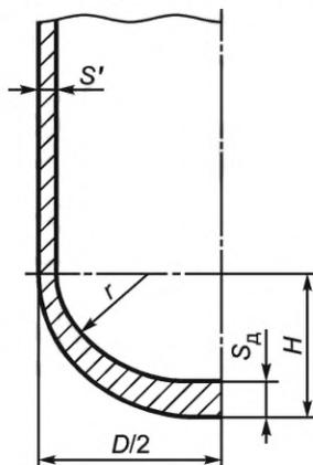
Рисунок 2 — Типовая конфигурация выпуклого глухого днища баллонов
