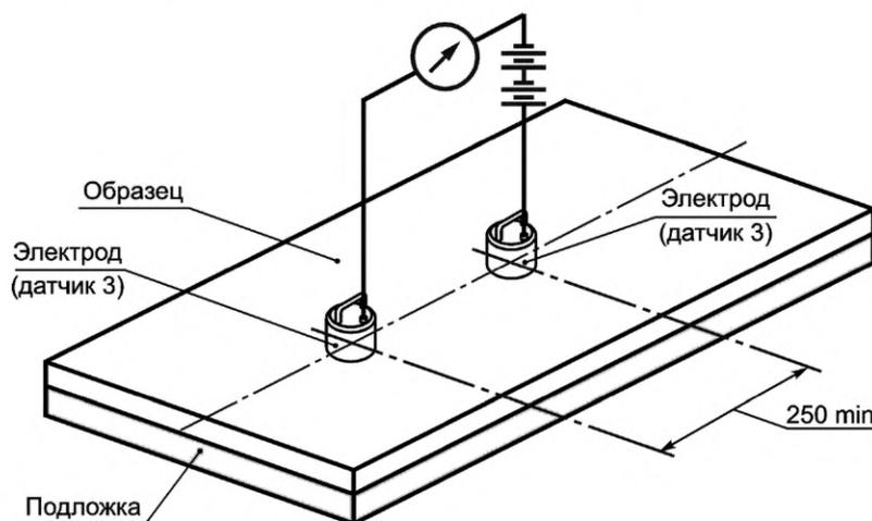
Рисунок 6 — Принцип измерения сопротивления «от точки до точки»
