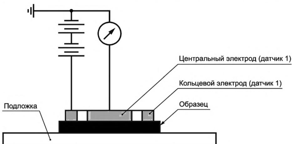
Рисунок 3 — Схема подключения электродов для измерения поверхностного сопротивления
