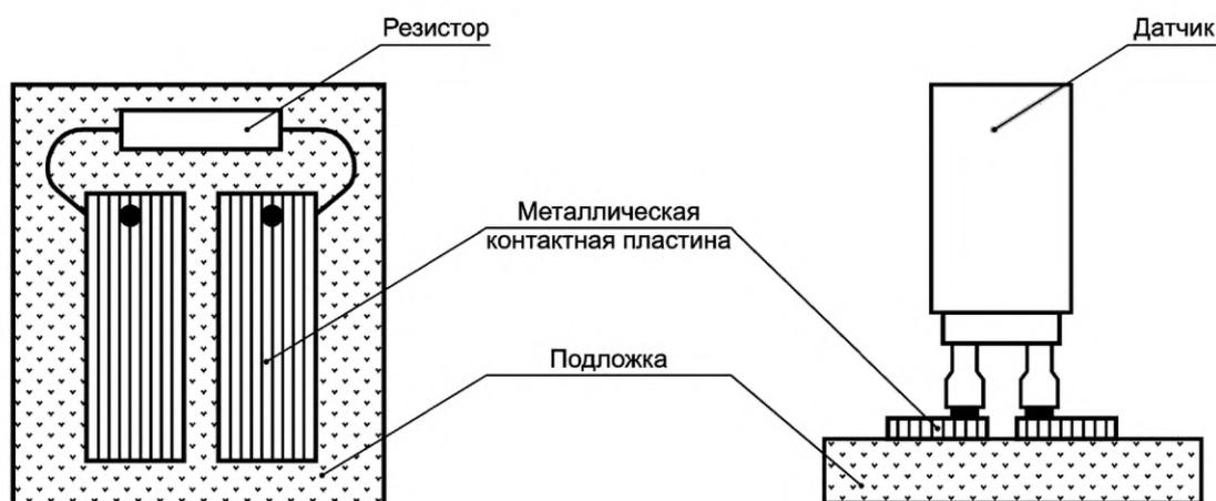
Рисунок А.3 — Устройство для проверки измерителя сопротивления
