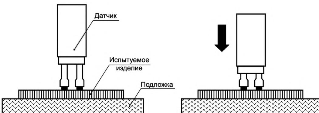
Рисунок 10 — Пример прижатия пружин при проведении испытаний
