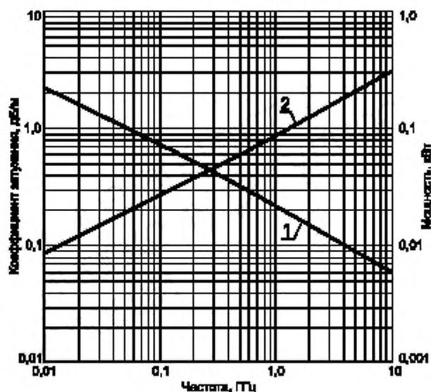
1 — допустимая мощность  $P$  на входе при температуре  $40\text{ }^{\circ}\text{C}$  и коэффициенте стоячей волны напряжения, равном 1; 2 — коэффициент затухания  $\alpha$  при температуре  $20\text{ }^{\circ}\text{C}$
