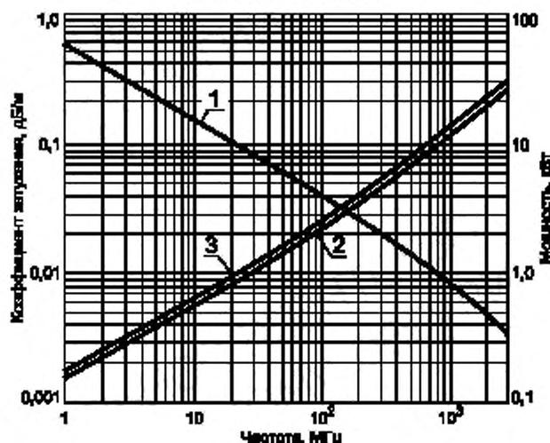
1 — допустимая мощность  $P$  на входе при температуре 40 °С и коэффициенте стоячей волны напряжения, равном 1;
