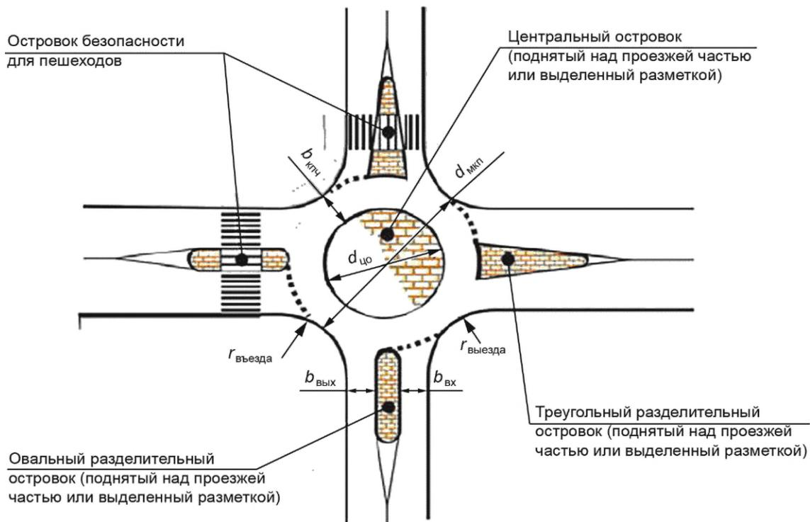
$d_{\text{мкп}}$  — диаметр мини-кольцевого пересечения;  $d_{\text{цo}}$  — диаметр центрального островка;  $b_{\text{кпч}}$  — ширина кольцевой проезжей части;  $b_{\text{вх}}$  и  $b_{\text{вых}}$  — ширины проезжей части при въезде и выезде с кольца;  $r_{\text{въезда}}$  и  $r_{\text{выезда}}$  — радиусы кромок проезжей части (бортового камня) при въезде на кольцо и выезде с кольцевой проезжей части
