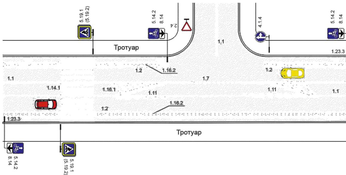
Рисунок Б.20 — Уменьшение ширины проезжей части с устройством велополос и выделением полосы для поворота налево
