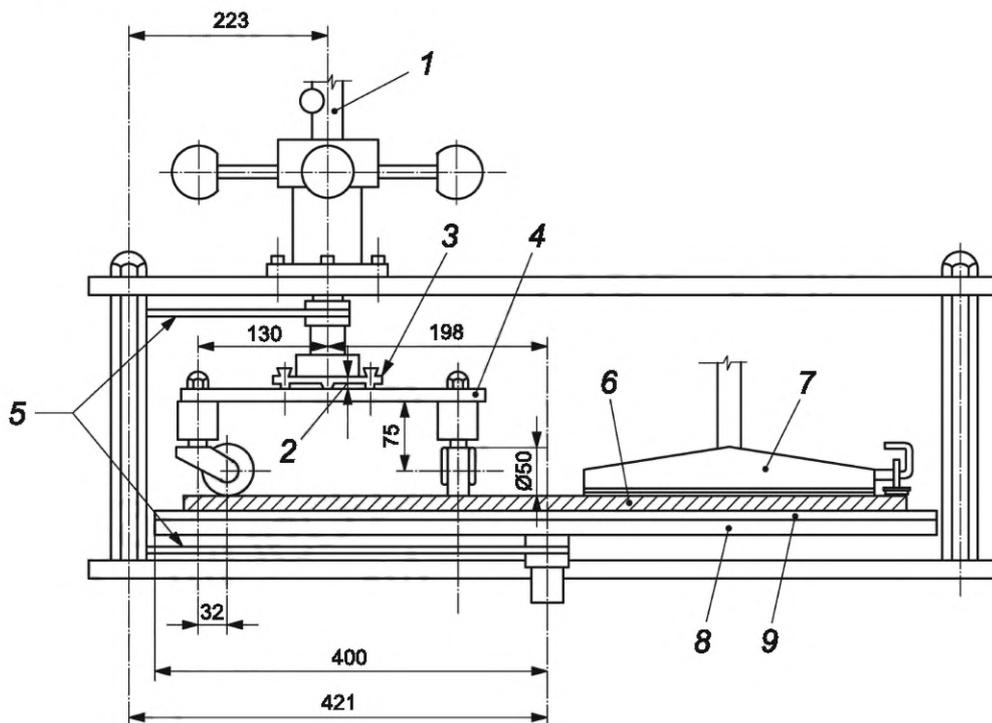
1 — груз массой 90 кг; 2 — зазор более 3 мм; 3 — загрузочная/приводная плита; 4 — опорная пластина для роликов; 5 — цепь; 6 — образец для испытаний; 7 — всасывающее устройство с регулировкой высоты; 8 — вращающаяся круглая испытательная платформа; 9 — подставка для образцов для испытаний
