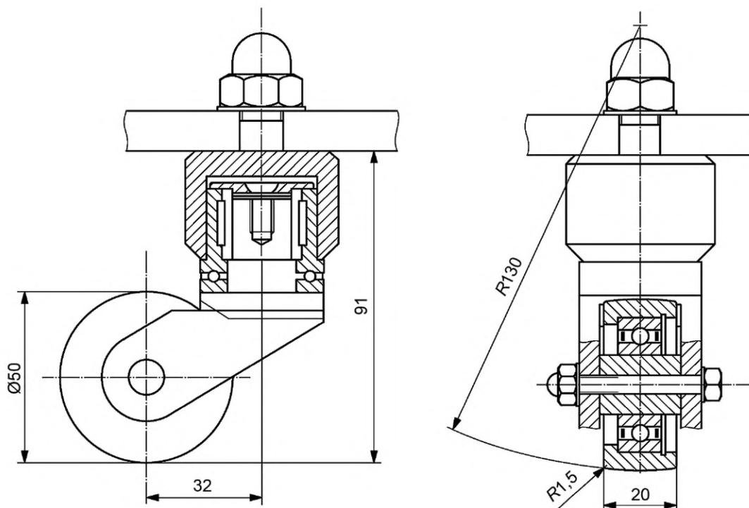
Рисунок 3 — Одноколесные поворотные ролики
