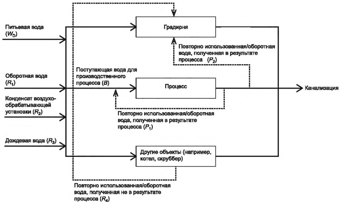
Рисунок С.2 — Иллюстрация для расчета коэффициента переработки
