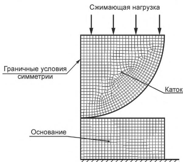
Рисунок Б.1 — Пример расчетной схемы катковой опоры
