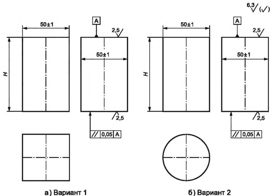
$$H = (1 \pm 0,1) \cdot H_0, \text{ где } H_0 \text{ — номинальная толщина металла в зоне контроля}$$
