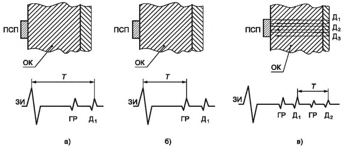
$T$  — время прохождения акустического пути;  $D_1$ — $D_2$  — донные эхо-сигналы; ГР — эхо-сигналы от границы сплавления
