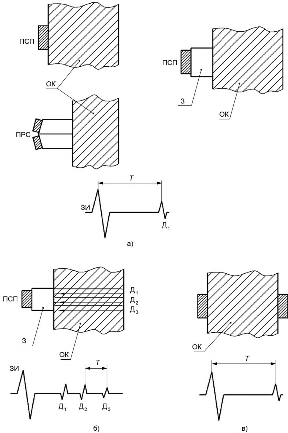
З — линия задержки;  $T$  — время прохождения акустического пути; Д<sub>1</sub>—Д<sub>3</sub> — донные эхо-сигналы
