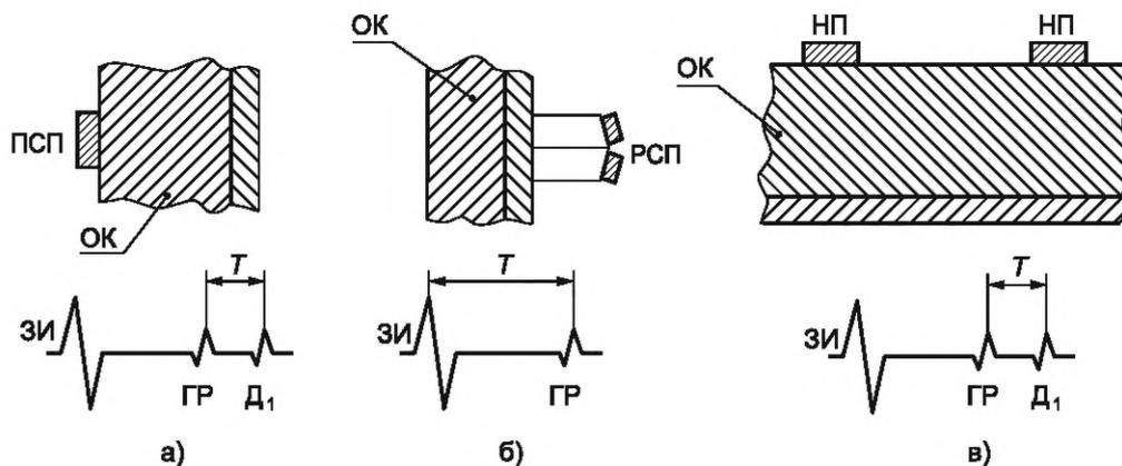
$T$  — время прохождения акустического пути;  $D_1$  — донный эхо-сигнал; ГР — эхо-сигнал от границы сплавления
