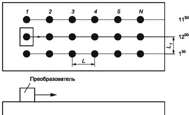
$L$  — расстояние между точками измерений (не менее 25 и не более 150 мм) в зависимости от размера (диаметра) ОК;  $L_1$  — расстояние между двумя соседними проходами
