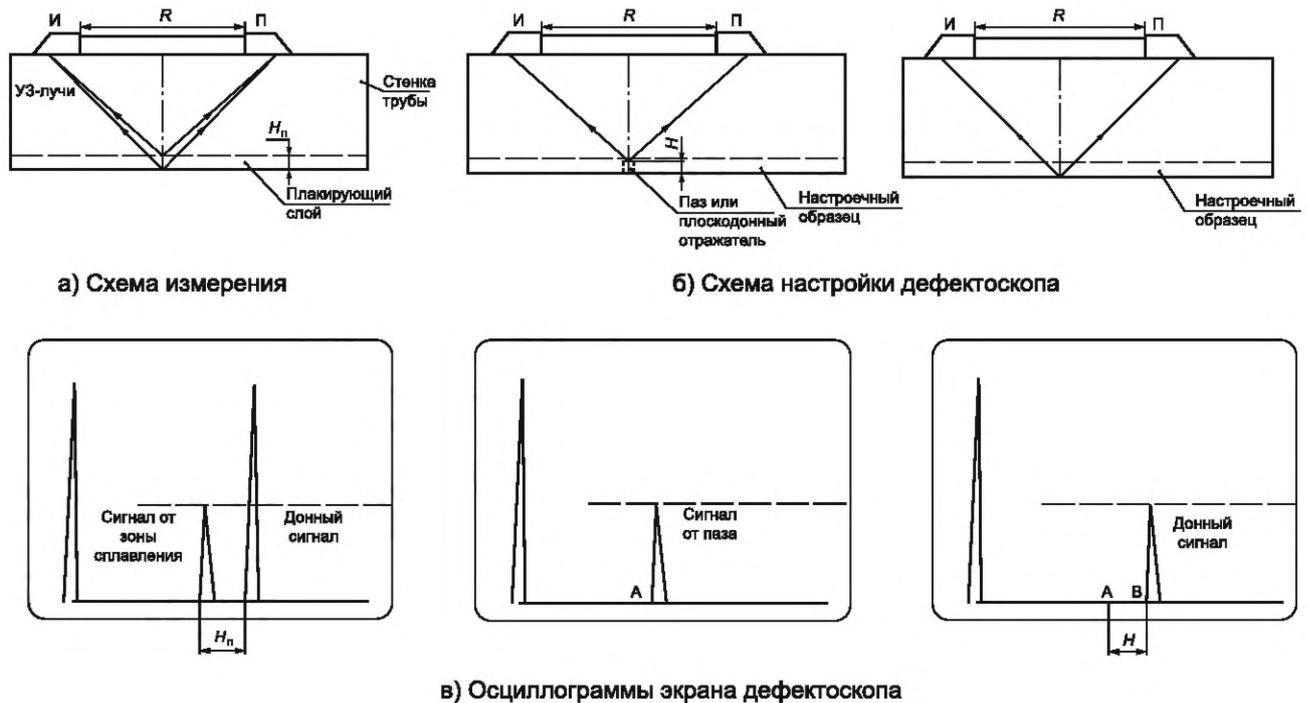
И — излучатель; П — приемник;  $H_n$  — толщина АНП;  $H$  — глубина паза (плоскодонного отверстия)
