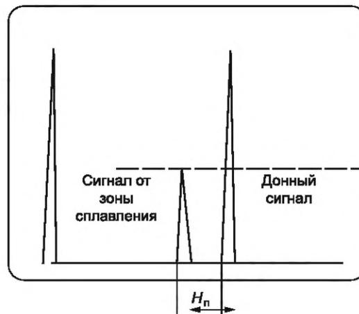
И — излучатель; П — приемник;  $H_n$  — толщина АНП
