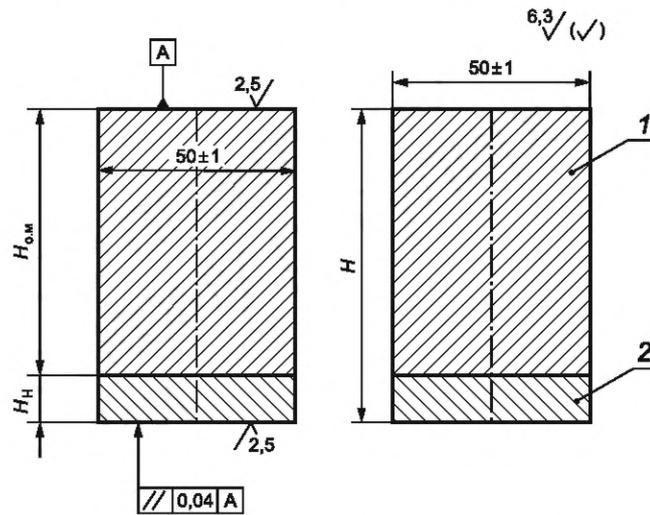
1 — основной металл; 2 — наплавленный слой
