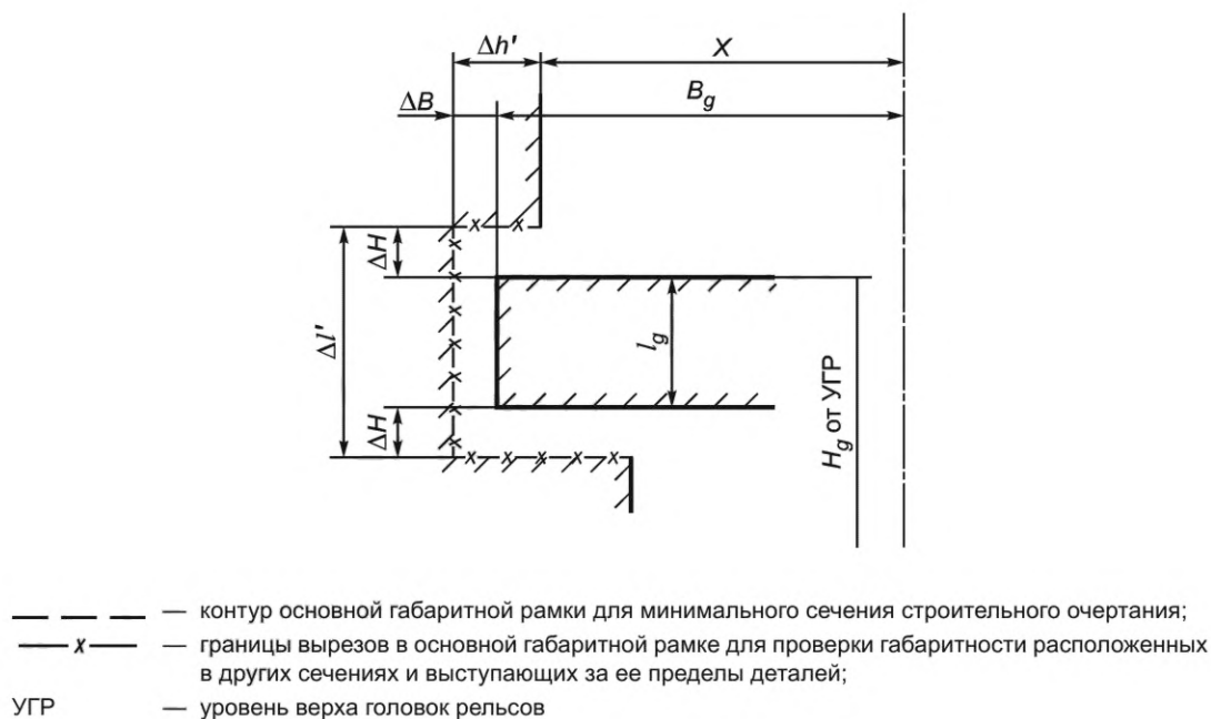
Рисунок Л.4 — Схема определения вертикального выреза для негабаритной детали
