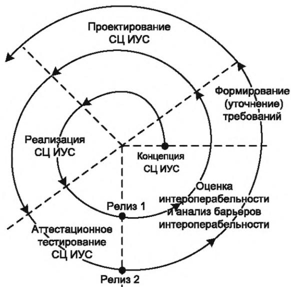
Рисунок 5 — Спиральный (эволюционный) жизненный цикл разработки СЦ ИУС
