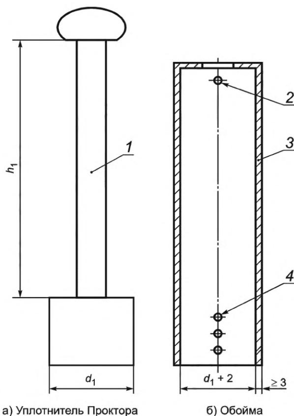
1 — штанга уплотнителя Проктора; 2 — отверстия; 3 — направляющая обойма; 4 — отверстия
