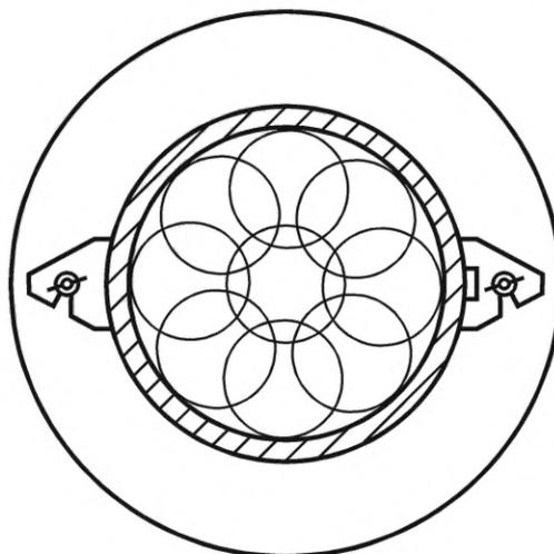
Рисунок 4 — Схема нанесения ударов при уплотнении
