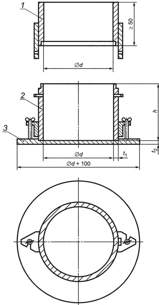
1 — удлинительное кольцо; 2 — цилиндрическая часть формы; 3 — основание формы
