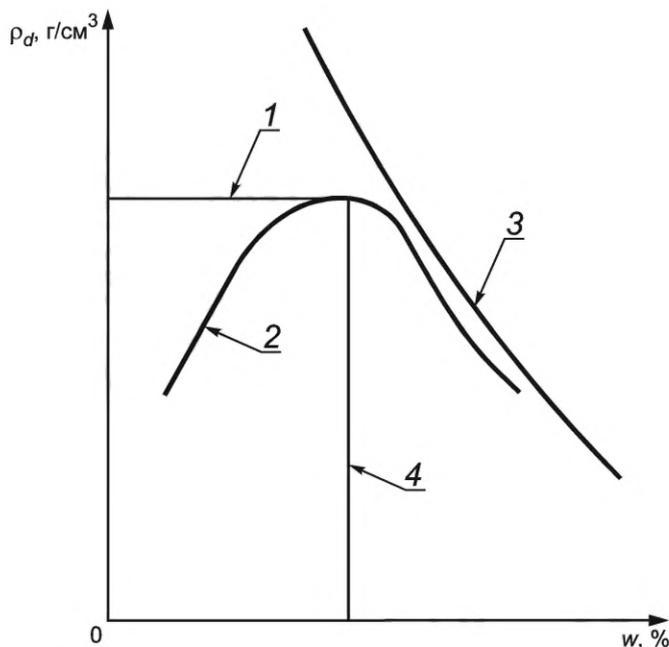
1 — значение максимальной плотности; 2 — график испытания; 3 — линия нулевого содержания воздуха;
