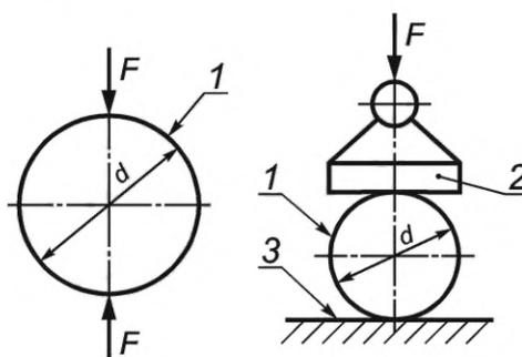
1 — образец; 2 — верхняя опорная плита; 3 — нижняя опорная плита
