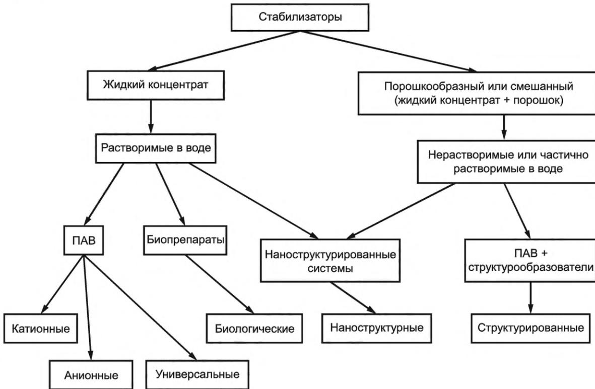
Рисунок Б.1 — Общая классификация стабилизаторов грунтов, применяемых в дорожном строительстве
