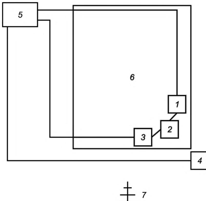
1 — АКТИВНАЯ ПРИНАДЛЕЖНОСТЬ; 2 — нагрузка; 3 — НЭ или губка, вымоченная в соляном растворе; 4 — ножной выключатель; 5 — ВЫСОКОЧАСТОТНЫЙ ЭЛЕКТРОХИРУРГИЧЕСКИЙ АППАРАТ; 6 — непроводящий стол; 7 — антенна — расстояние 10 м, вертикальная поляризация
