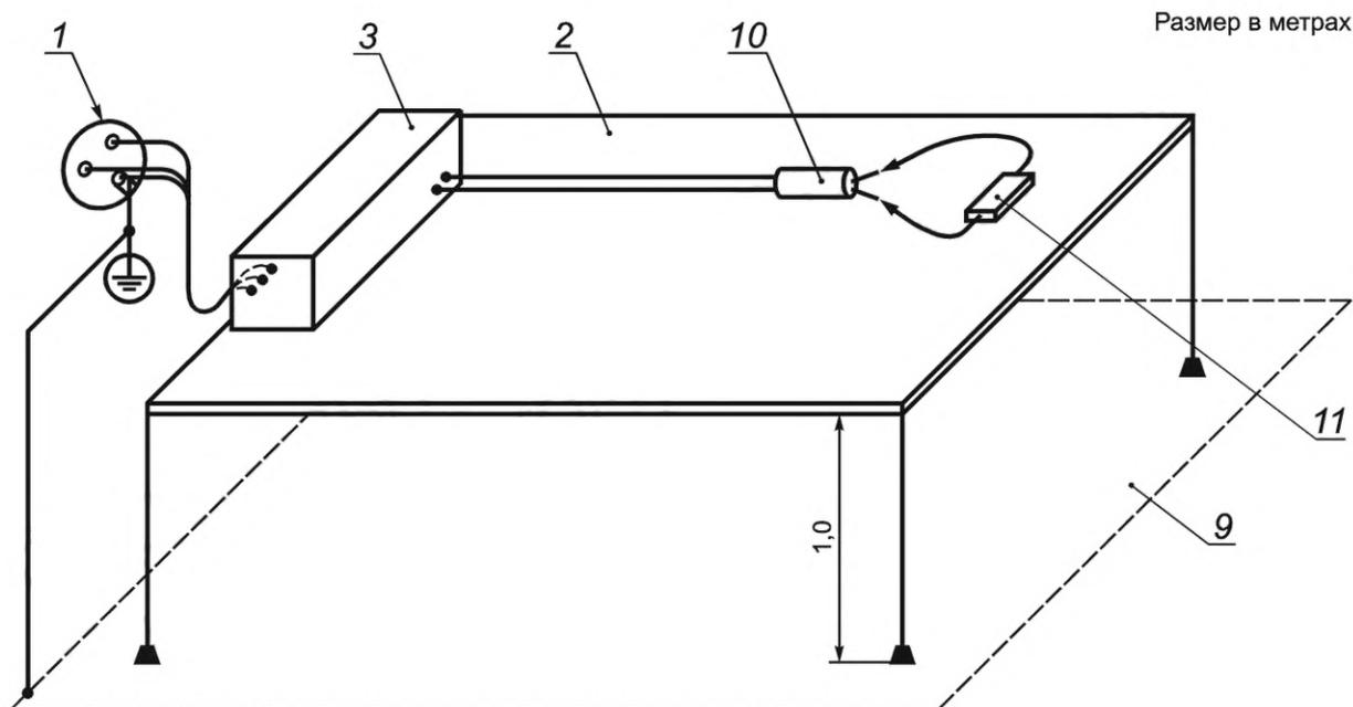
1 — ПИТАЮЩАЯ СЕТЬ; 2 — стол, изготовленный из изолирующего материала; 3 — ВЫСОКОЧАСТОТНЫЙ ЭЛЕКТРОХИРУРГИЧЕСКИЙ АППАРАТ; 9 — заземленная проводящая поверхность; 10 — активированная БИПОЛЯРНАЯ ПРИНАДЛЕЖНОСТЬ; 11 — требуемое сопротивление нагрузки с устройством измерения ВЫСОКОЧАСТОТНОЙ мощности
