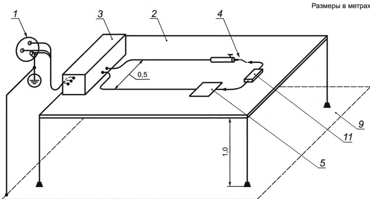
1 — ПИТАЮЩАЯ СЕТЬ; 2 — стол, изготовленный из изолирующего материала; 3 — ВЫСОКОЧАСТОТНЫЙ ЭЛЕКТРОХИРУРГИЧЕСКИЙ АППАРАТ; 4 — АКТИВНЫЙ ЭЛЕКТРОД; 5 — НЕЙТРАЛЬНЫЙ ЭЛЕКТРОД, металлический или контактирующий с металлической фольгой такого же размера; 9 — заземленная проводящая поверхность; 11 — требуемое сопротивление нагрузки с устройством измерения ВЫСОКОЧАСТОТНОЙ мощности
