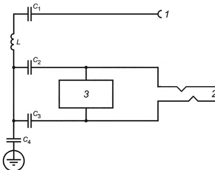
1 — соединитель для АКТИВНОГО ЭЛЕКТРОДА; 2 — соединитель для НЕЙТРАЛЬНОГО ЭЛЕКТРОДА; 3 — монитор;
