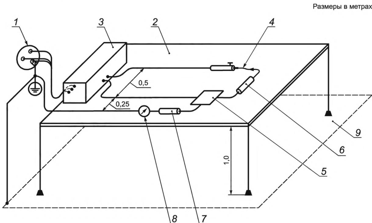
1 — ПИТАЮЩАЯ СЕТЬ; 2 — стол, изготовленный из изолирующего материала; 3 — ВЫСОКОЧАСТОТНЫЙ ЭЛЕКТРОХИРУРГИЧЕСКИЙ АППАРАТ; 4 — АКТИВНЫЙ ЭЛЕКТРОД; 5 — НЕЙТРАЛЬНЫЙ ЭЛЕКТРОД, металлический или контактирующий с металлической фольгой такого же размера; 6 — сопротивление нагрузки, 200 Ом; 7 — измерительное сопротивление, 200 Ом; 8 — ВЫСОКОЧАСТОТНЫЙ амперметр; 9 — заземленная проводящая поверхность
