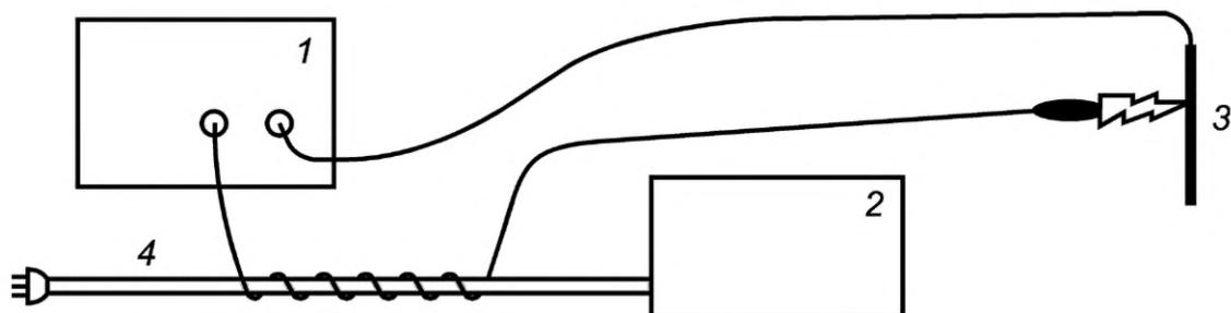
1 — ВЫСОКОЧАСТОТНЫЙ ЭЛЕКТРОХИРУРГИЧЕСКИЙ АППАРАТ; 2 — испытуемый блок; 3 — металлическая пластина;
