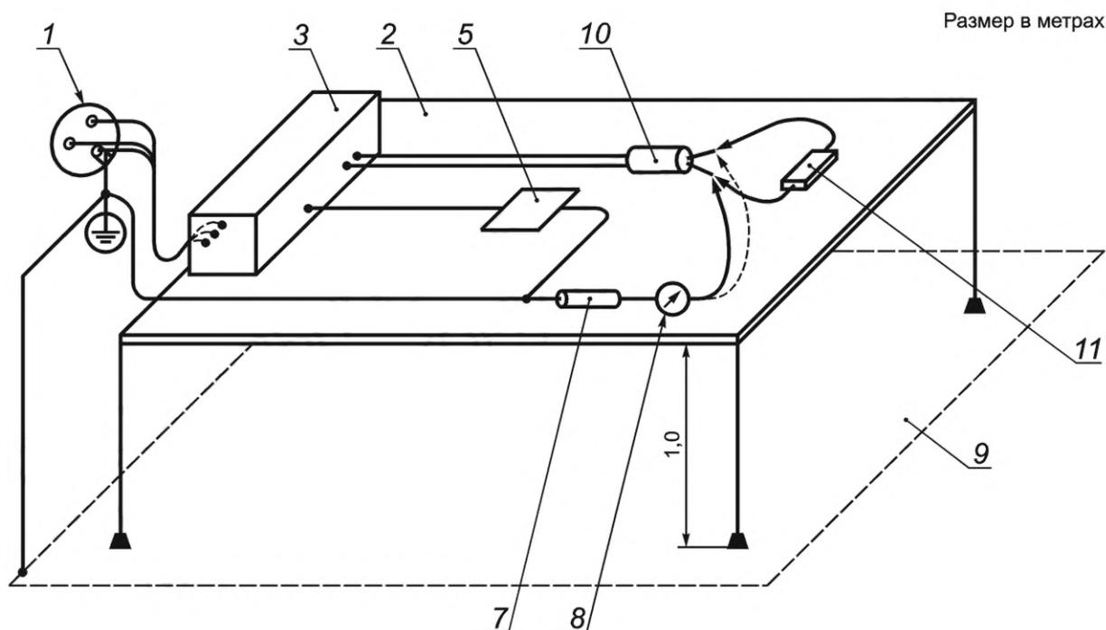
1 — ПИТАЮЩАЯ СЕТЬ; 2 — стол, изготовленный из изолирующего материала; 3 — ВЫСОКОЧАСТОТНЫЙ ЭЛЕКТРОХИРУРГИЧЕСКИЙ АППАРАТ; 5 — НЕЙТРАЛЬНЫЙ ЭЛЕКТРОД, металлический или контактирующий с металлической фольгой такого же размера; 7 — измерительное сопротивление, 200 Ом; 8 — ВЫСОКОЧАСТОТНЫЙ амперметр; 9 — заземленная проводящая поверхность; 10 — активированная БИПОЛЯРНАЯ ПРИНАДЛЕЖНОСТЬ; 11 — требуемое сопротивление нагрузки с устройством измерения ВЫСОКОЧАСТОТНОЙ мощности
