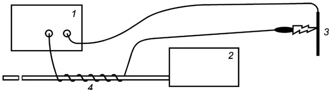
1 — ВЫСОКОЧАСТОТНЫЙ ЭЛЕКТРОХИРУРГИЧЕСКИЙ АППАРАТ; 2 — испытуемый блок; 3 — металлическая пластина;
