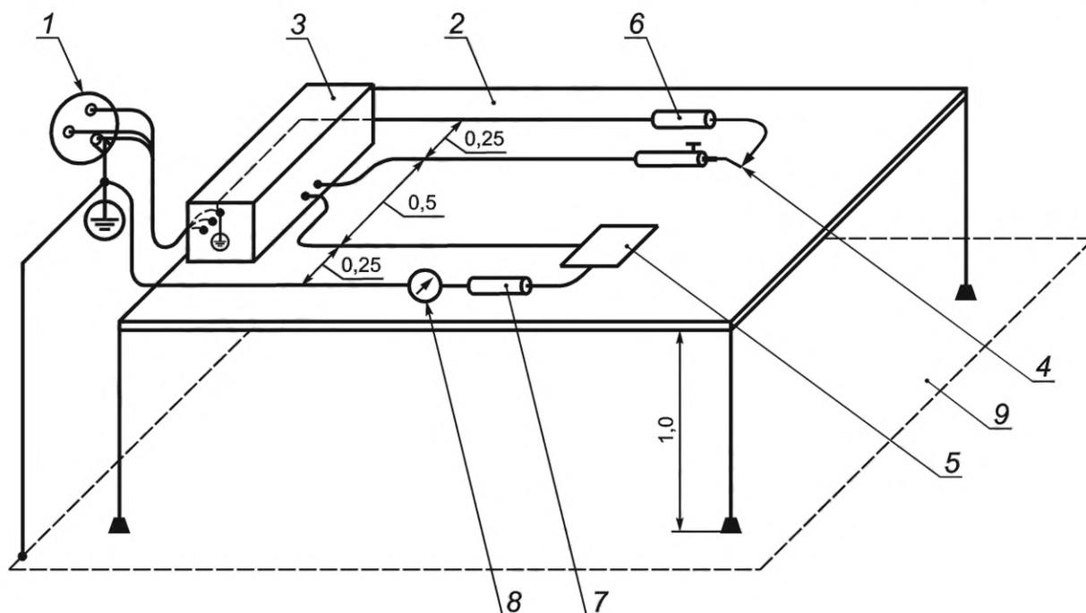
1 — ПИТАЮЩАЯ СЕТЬ; 2 — стол, изготовленный из изолирующего материала; 3 — **ВЫСОКОЧАСТОТНЫЙ ЭЛЕКТРОХИРУРГИЧЕСКИЙ АППАРАТ**; 4 — **АКТИВНЫЙ ЭЛЕКТРОД**; 5 — **НЕЙТРАЛЬНЫЙ ЭЛЕКТРОД**, металлический или контактирующий с металлической фольгой такого же размера; 6 — сопротивление нагрузки, 200 Ом; 7 — измерительное сопротивление, 200 Ом; 8 — **ВЫСОКОЧАСТОТНЫЙ амперметр**; 9 — заземленная проводящая поверхность
