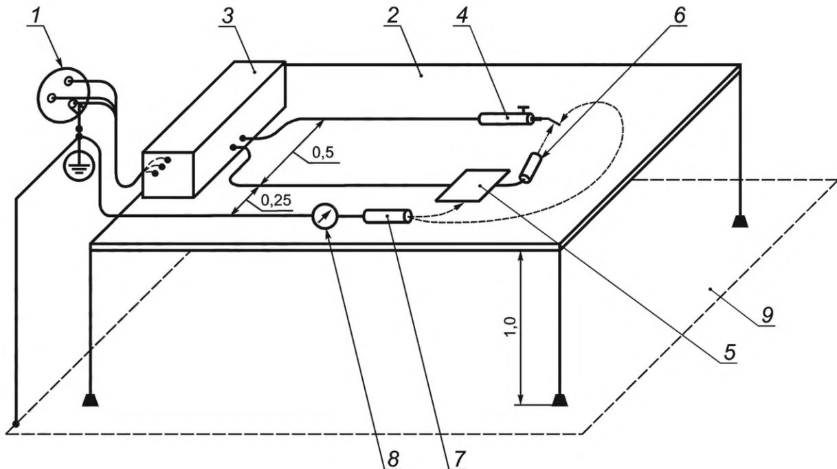
1 — ПИТАЮЩАЯ СЕТЬ; 2 — стол, изготовленный из изолирующего материала; 3 — ВЫСОКОЧАСТОТНЫЙ ЭЛЕКТРОХИРУРГИЧЕСКИЙ АППАРАТ; 4 — АКТИВНЫЙ ЭЛЕКТРОД; 5 — НЕЙТРАЛЬНЫЙ ЭЛЕКТРОД, металлический или контактирующий с металлической фольгой такого же размера; 6 — НОМИНАЛЬНАЯ НАГРУЗКА; 7 — измерительное сопротивление, 200 Ом; 8 — ВЫСОКОЧАСТОТНЫЙ амперметр; 9 — заземленная проводящая поверхность
