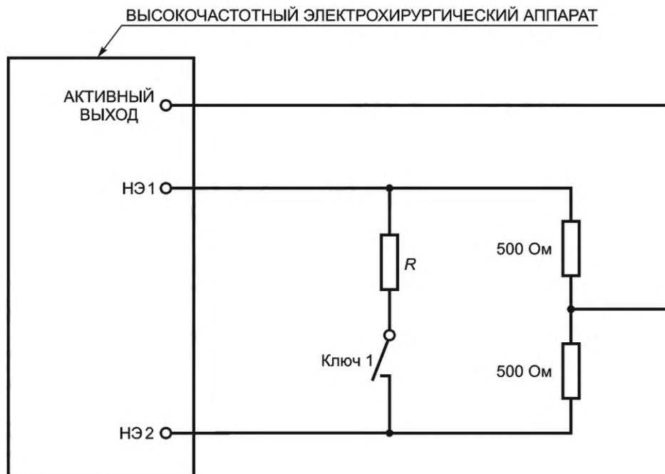
Для неразделенных пластин:  $R = 0$  Ом; для разделенных пластин: значение  $R$ , как определено ИЗГОТОВИТЕЛЕМ, такое, чтобы просто поддерживать оборудование активным при замкнутом ключе 1.
