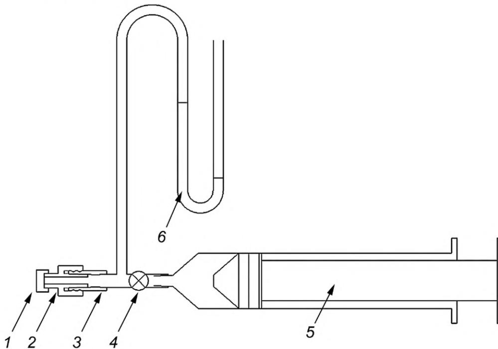
1 — герметичная пробка; 2 — тестируемый СОЕДИНИТЕЛЬ; 3 — эталонный СОЕДИНИТЕЛЬ; 4 — запорный клапан;
