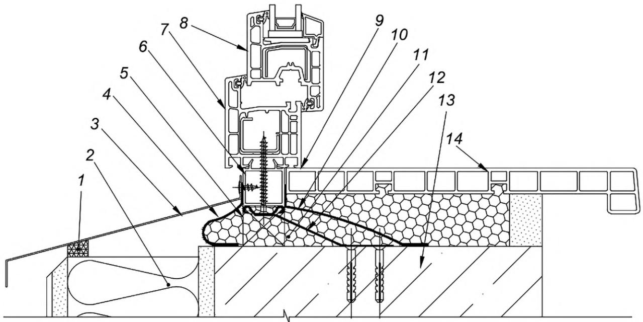
1 — саморасширяющаяся уплотнительная лента; 2 — теплоизолирующий слой; 3 — отлив; 4 — гидроизоляционная лента; 5 — опорная колодка; 6 — подставочный профиль; 7 — профиль коробки оконного блока; 8 — профиль створки оконного блока; 9 — герметик; 10 — пароизоляционная лента; 11 — монтажный шов; 12 — элемент крепления; 13 — стена; 14 — подоконная доска
