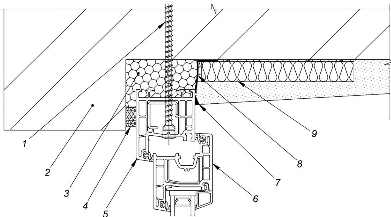
1 — элемент крепления; 2 — стена; 3 — монтажный шов; 4 — саморасширяющаяся уплотнительная лента; 5 — профиль коробки оконного блока; 6 — профиль створки оконного блока; 7 — герметик; 8 — пароизоляционная лента; 9 — теплоизоляционный вкладыш
