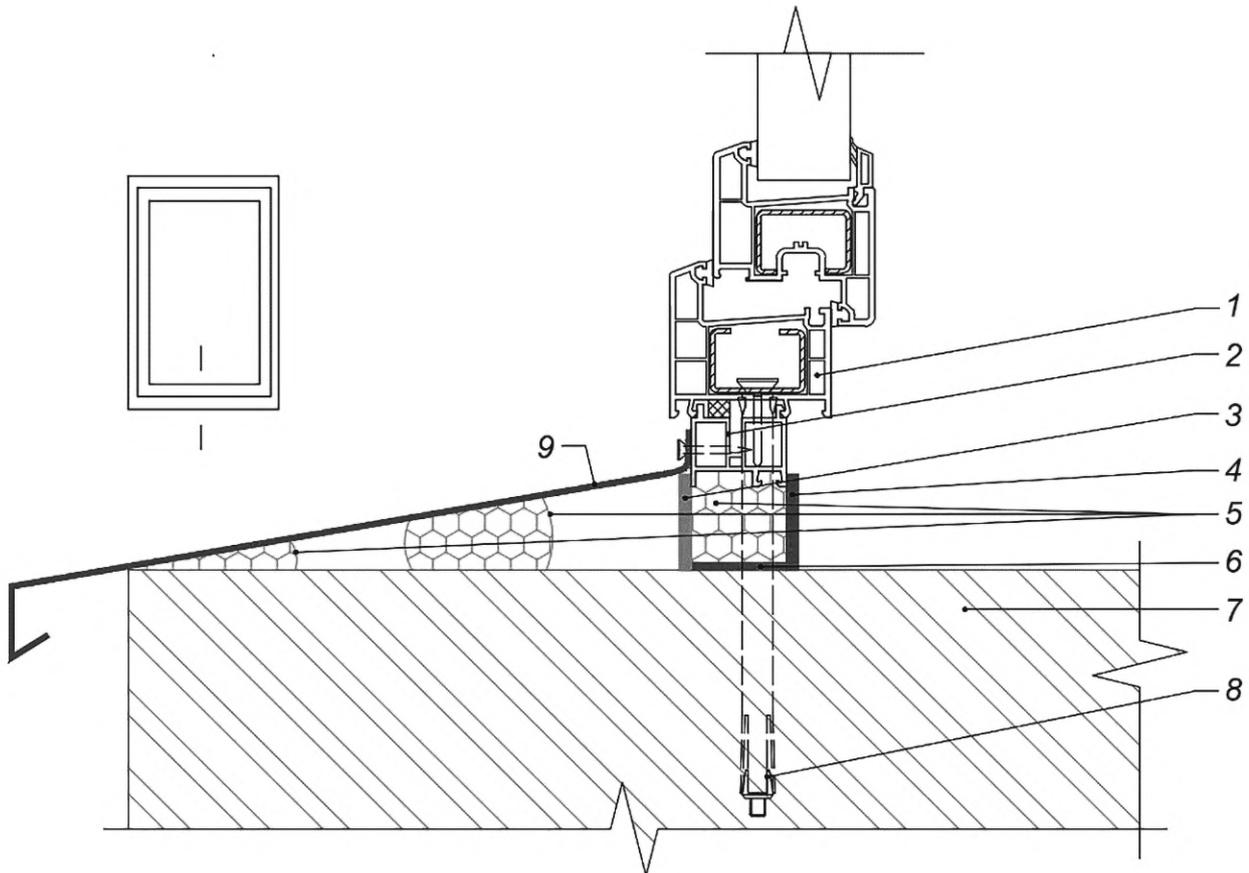
1 — оконный блок; 2 — подставочный профиль; 3 — паропроницаемый герметик; 4 — пароизоляционный герметик;
