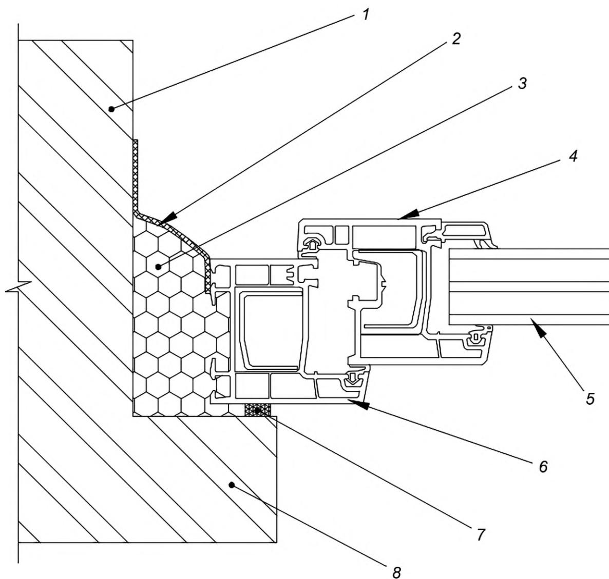
1 — стена; 2 — пароизоляция монтажного шва; 3 — монтажный шов; 4 — профиль створки оконного блока;
