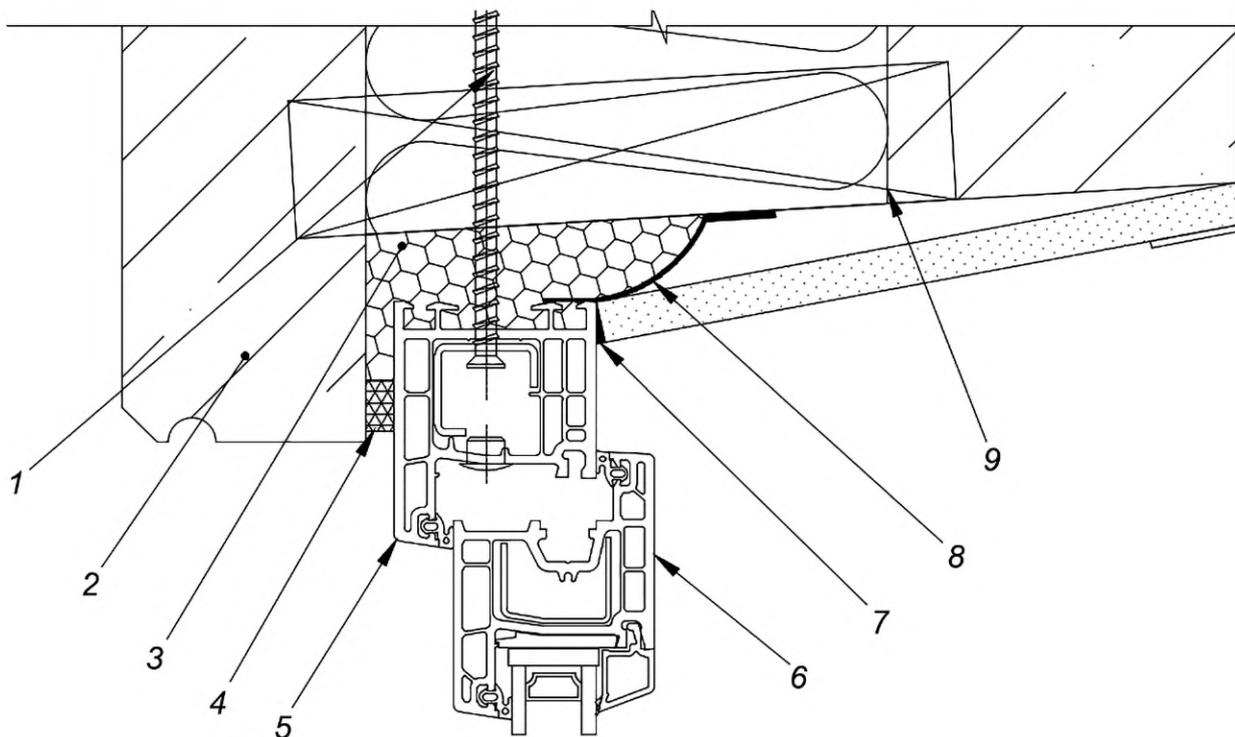
1 — элемент крепления; 2 — стена; 3 — монтажный шов; 4 — саморасширяющаяся уплотнительная лента;
