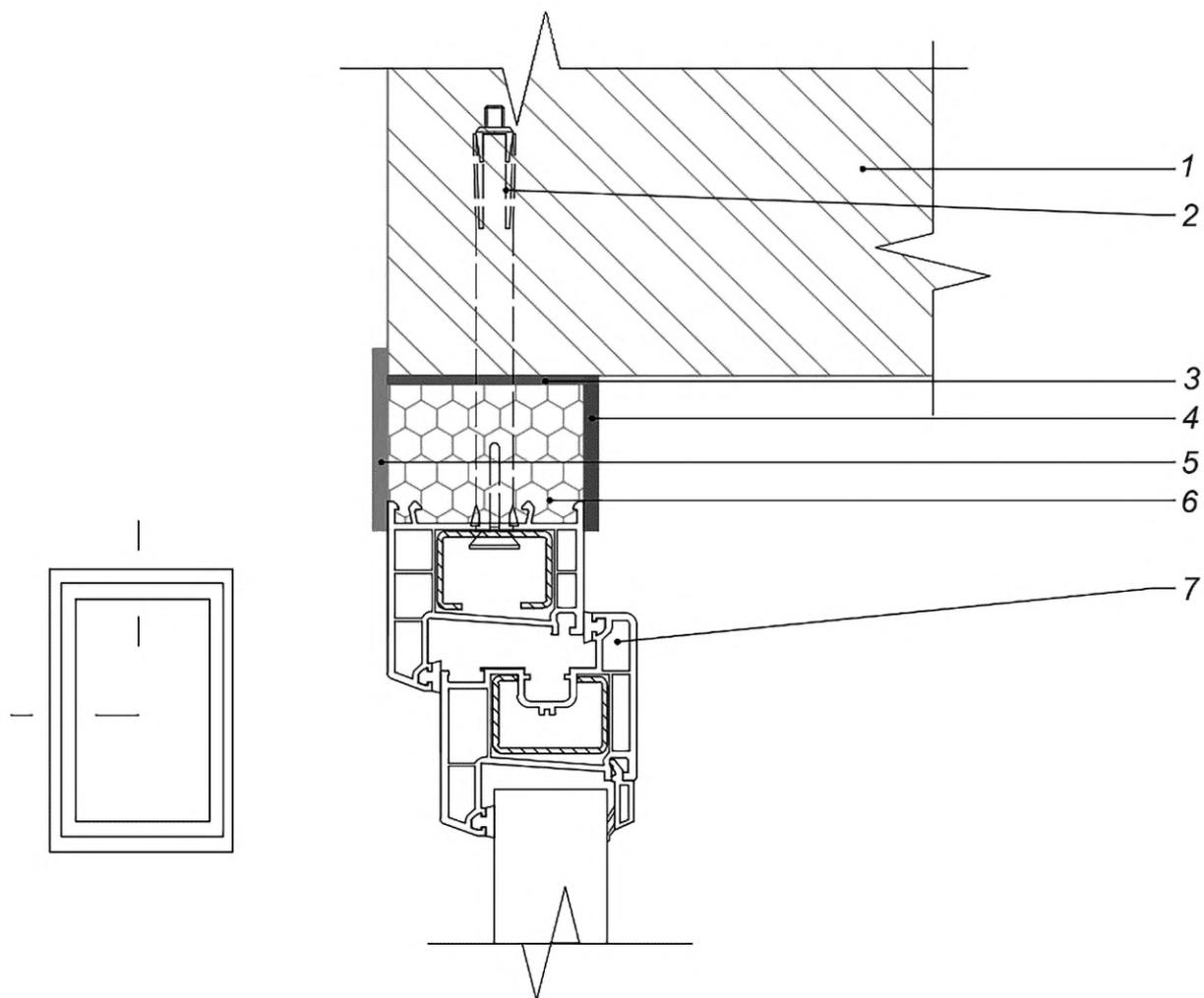
1 — кирпичная стена; 2 — анкерный дюбель; 3 — дополнительный водо- и пароизоляционный слой монтажного шва\*; 4 — пароизоляционный герметик; 5 — паропроницаемый герметик; 6 — монтажная пена; 7 — оконный блок
