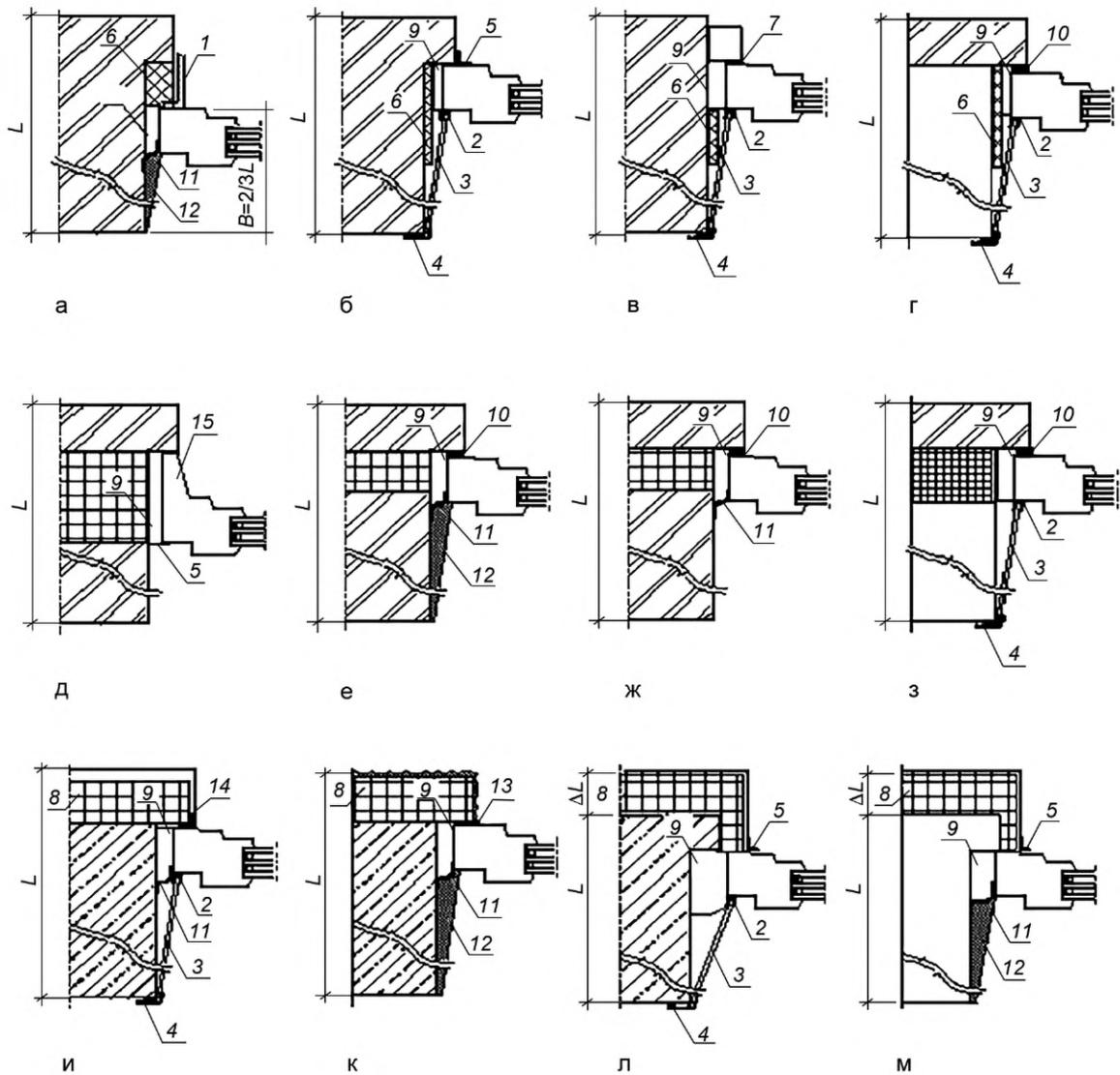
а, б, в, г — однослойные или двухслойные стены без эффективного утеплителя; д, е, ж, з — многослойные стены с эффективным утеплителем, расположенным в толще стены; и, к, л, м — наружные стены с фасадной теплоизоляцией;
