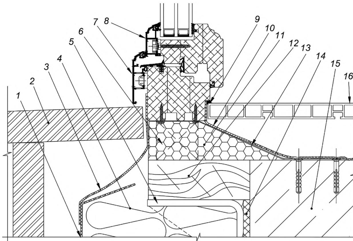
1 — гидроветрозащита теплоизоляционного слоя; 2 — детали внешней отделки; 3 — гидроизоляционная лента; 4 — теплоизоляционный слой; 5 — выносной кронштейн крепления оконного блока; 6 — опорная колодка; 7 — профиль коробки оконного блока; 8 — профиль створки оконного блока; 9 — герметик; 10 — пароизоляционная лента; 11 — монтажный шов; 12 — доска антисептированная; 13 — элемент крепления; 14 — паронит; 15 — стена; 16 — подоконная доска
