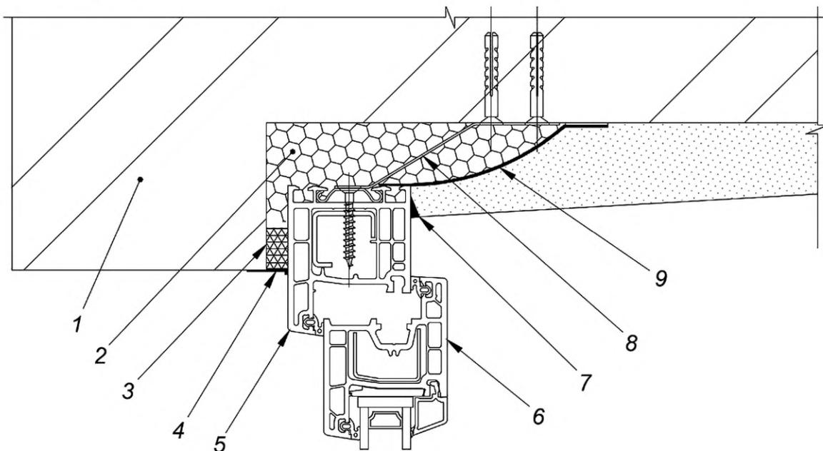
1 — стена; 2 — монтажный шов; 3 — саморасширяющаяся уплотнительная лента; 4 — паропроницаемый герметик; 5 — профиль коробки оконного блока; 6 — профиль створки оконного блока; 7 — герметик; 8 — элемент крепления; 9 — пароизоляционная лента
