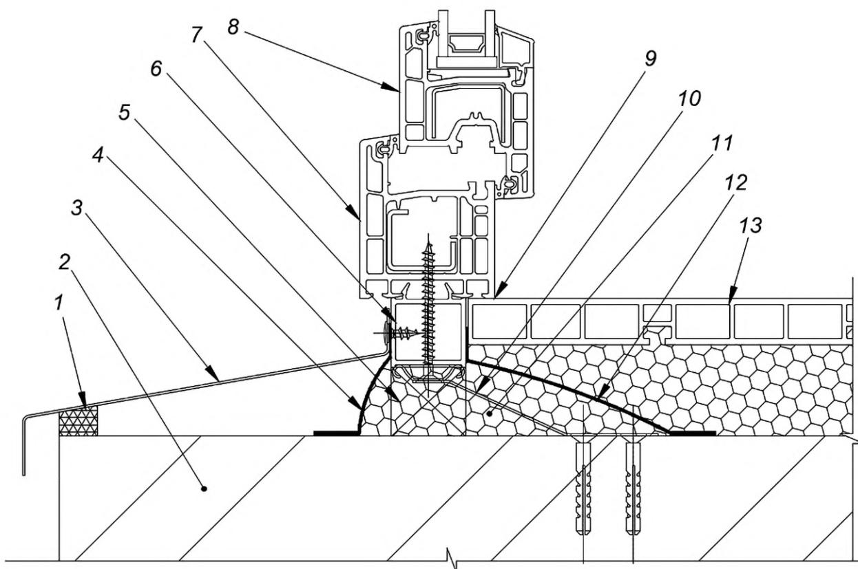
1 — саморасширяющаяся уплотнительная лента; 2 — стена; 3 — отлив; 4 — гидроизоляционная лента; 5 — опорная колодка; 6 — подставочный профиль; 7 — профиль коробки оконного блока; 8 — профиль створки оконного блока; 9 — герметик; 10 — элемент крепления; 11 — монтажный шов; 12 — пароизоляционная лента; 13 — подоконная доска
