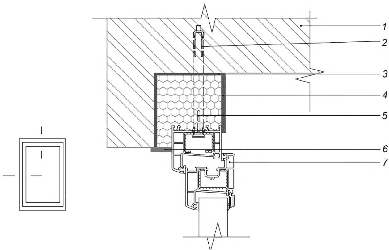
1 — кирпичная стена; 2 — анкерный дюбель; 3 — дополнительный водо- и пароизоляционный слой монтажного шва\*; 4 — пароизоляционный герметик; 5 — монтажная пена; 6 — паропроницаемый герметик; 7 — оконный блок
