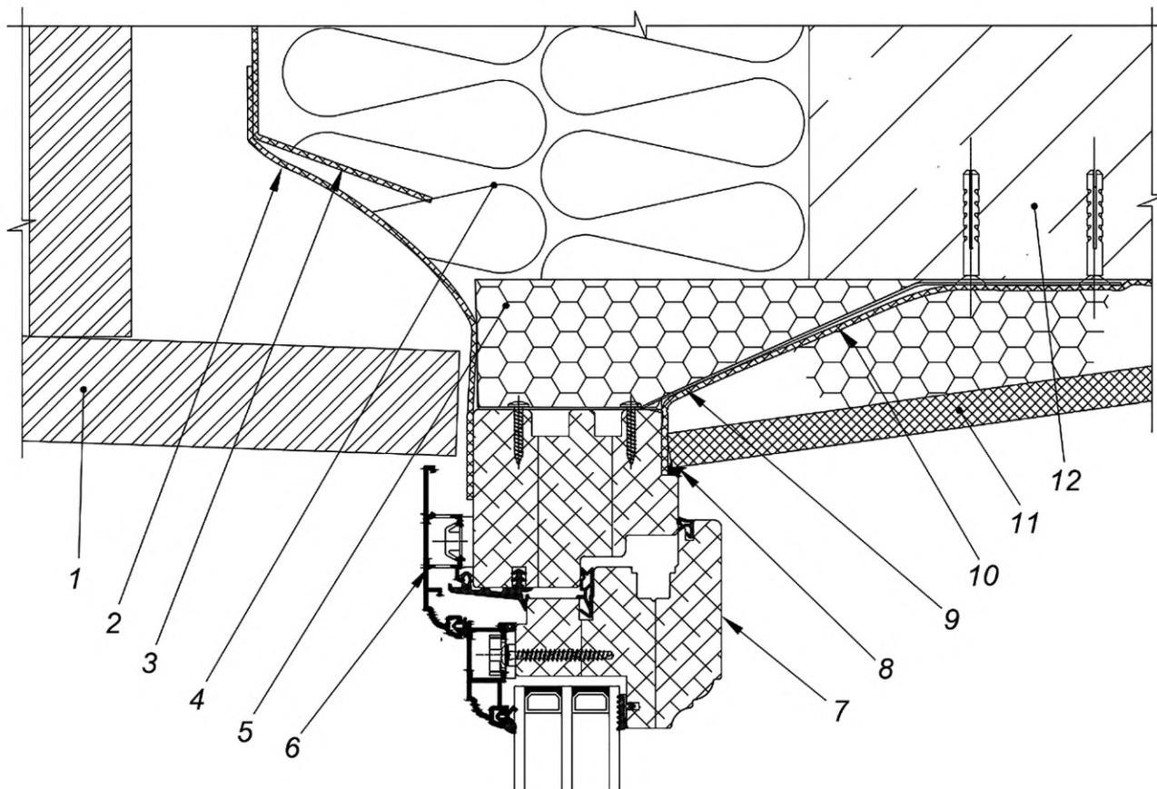
1 — детали внешней отделки; 2 — гидроизоляционная лента; 3 — гидроветрозащита теплоизоляционного слоя; 4 — теплоизоляционный слой; 5 — монтажный шов; 6 — профиль коробки оконного блока; 7 — профиль створки оконного блока; 8 — герметик; 9 — элемент крепления; 10 — пароизоляционная лента; 11 — элемент отделки внутренних откосов; 12 — стена
