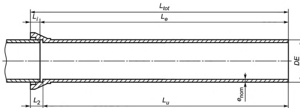
$DE$  — номинальный наружный диаметр труб с гладким концом, мм;  $e_{\text{ном}}$  — номинальная толщина стенки, мм;  $L_2$  — глубина раструба, м;  $L_e = L_{\text{tot}} - L_i$  — уложенная длина, м;  $L_i$  — максимальная глубина вставки, согласно изготовителю, м;  $L_{\text{tot}}$  — полная длина, м;  $L_u = L_{\text{tot}} - L_2$  — действительная длина, м
