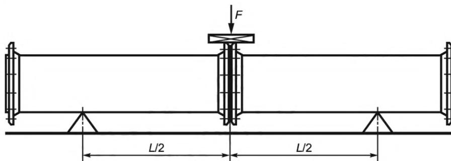
Рисунок 3 — Испытание на прочность и герметичность фланцевых соединений
