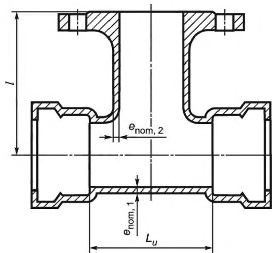
Рисунок 13 — Тройник с двумя раструбами и фланцевым отводом
