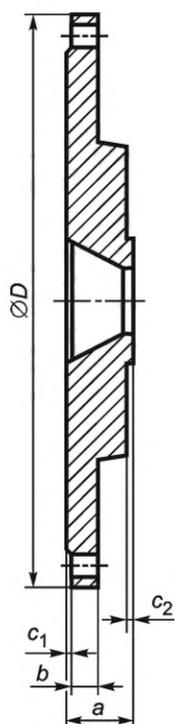
Рисунок 26 — Переходной фланец *PN 25*
