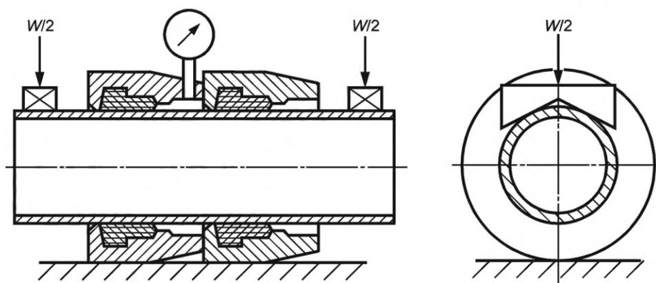
Рисунок 2 — Герметичность соединения при испытании внешним давлением
