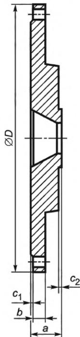
Рисунок 24 — Переходной фланец *PN 10*
