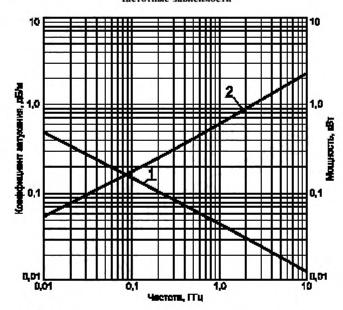
I — допустимая мощность F на входе при температуре 40 °C и коэффициенте стоячей волны напряжения, равном 1; 2 — коэффициент затухания  $\alpha$  при температуре 20 °C
