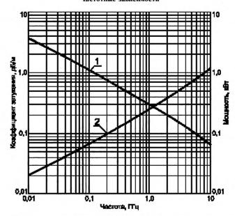
I — допустимая мощность P на входе при температуре 40 °C и коэффициенте стоячей волны напряжения, равном 1; 2 — коэффициент затухания  $\alpha$  при температуре 20 °C
