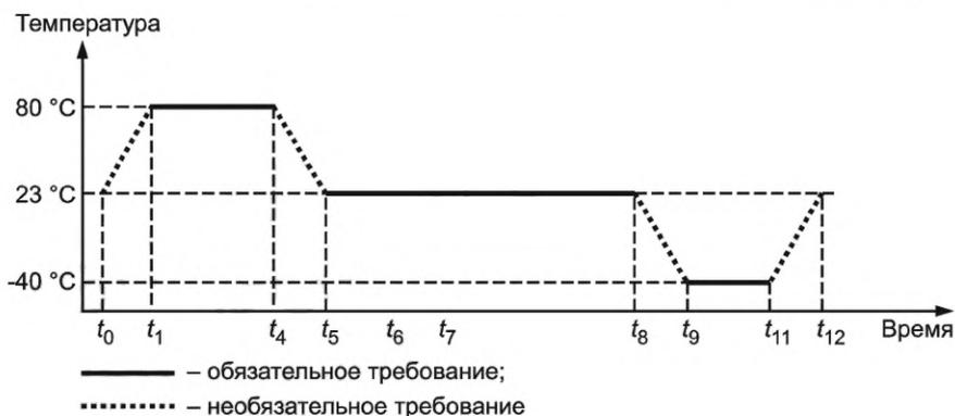
Рисунок Ж.3 — График изменения температуры в климатической камере в течение одного рабочего цикла
