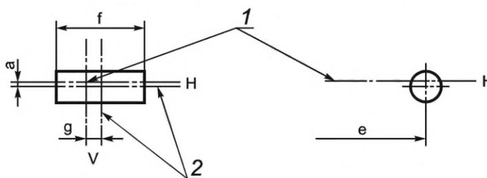
1 — базовая ось; 2 — оси тела накала лампы
