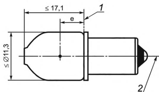
1 — базовая плоскость; 2 — базовая ось
