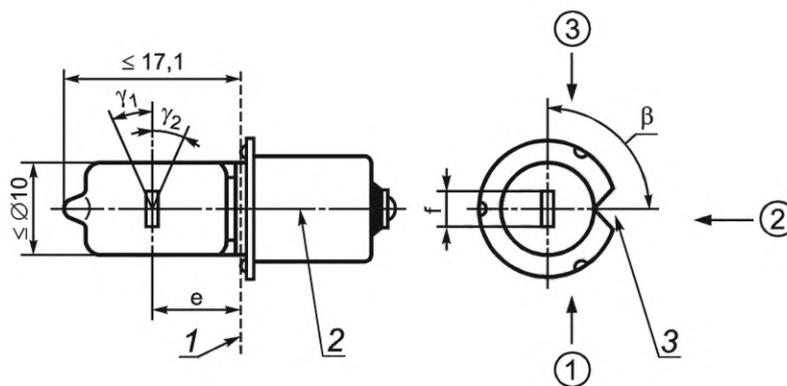
1 — базовая плоскость; 2 — базовая ось; 3 — базовый паз
