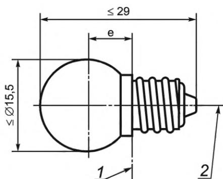
1 — базовая плоскость; 2 — базовая ось
