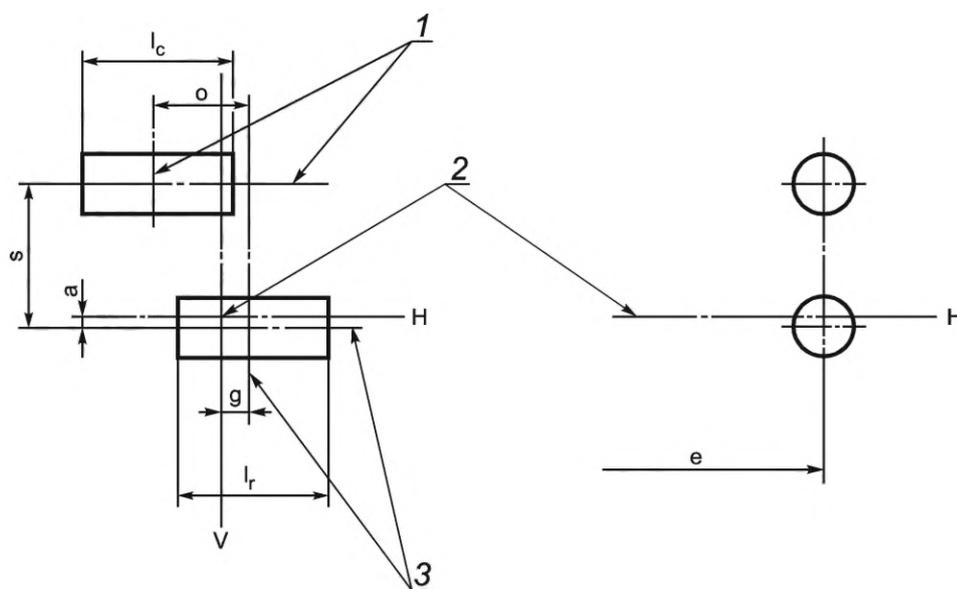
1 — оси тела накала лампы; 2 — базовая ось; 3 — оси тела накала лампы дальнего света
