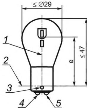
1 — базовая ось; 2 — базовая плоскость (см. примечание 4 на С. 2/2); 3 — базовый штифт; 4 — тело накала дальнего света; 5 — тело накала ближнего света
