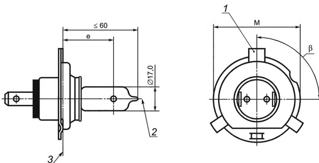
1 — базовый выступ; 2 — базовая ось; 3 — базовая плоскость
