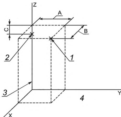
1 — фактический центр тела накала лампы; 2 — расчетный центр тела накала лампы; 3 — базовая ось; 4 — базовая плоскость
