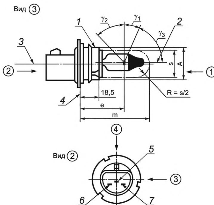
1 — базовый паз (паз R); 2 — центральная линия неискривленной колбы; 3 — базовая ось; 4 — базовая поверхность; 5 — контакт тела накала ближнего света; 6 — контакт общий; 7 — контакт тела накала дальнего света
