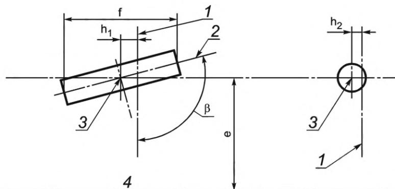
1 — базовая ось; 2 — ось тела накала лампы; 3 — центр тела накала лампы; 4 — базовая плоскость
