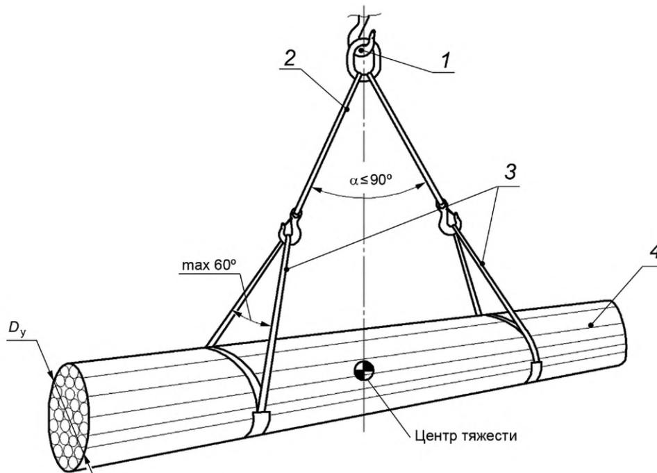
$D_y$  — условный диаметр груза; 1 — грузозахватный орган подъемного устройства;
