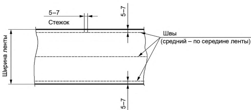
Рисунок 12 — Трехшовная сшивка
