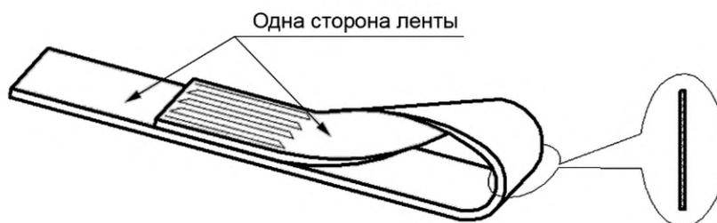
Рисунок 8 — Скрученная петля стропа
