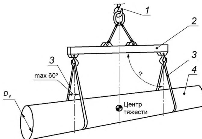
Примечание — Угол  $\alpha$  равен  $90^\circ \pm 5^\circ$  (вертикальное положение)
