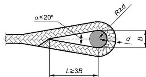
$B$  — ширина или диаметр концевой части стропы или соответствующий размер соединительного звена или грузозахватного органа подъемного устройства;
