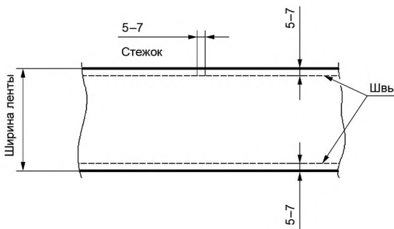
Рисунок 11 — Двухшовная сшивка
