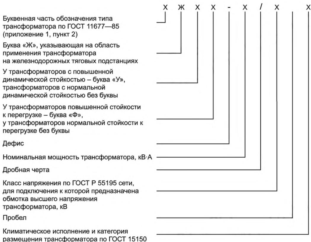
Рисунок 1 – Структурная схема условного обозначения трансформатора
