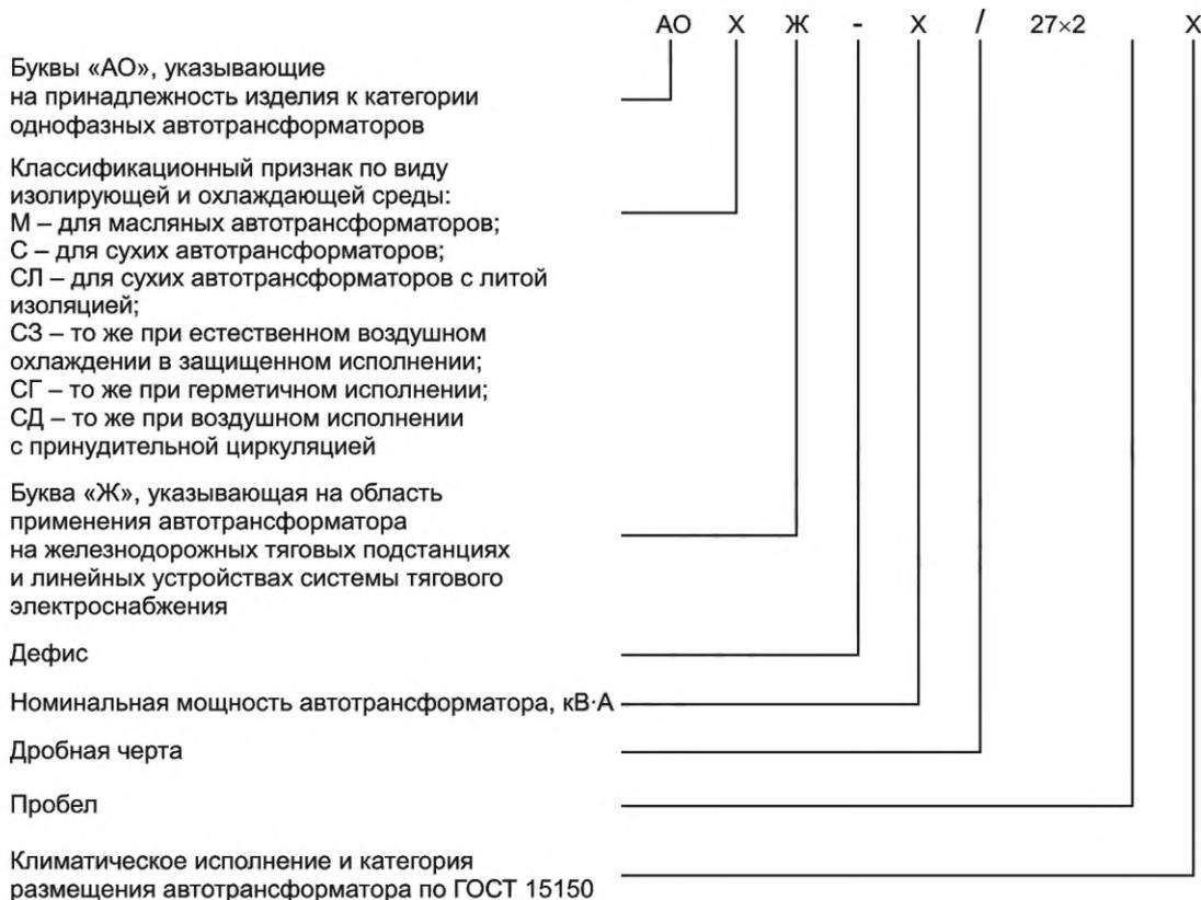
Рисунок 2 — Структурная схема условного обозначения автотрансформатора
