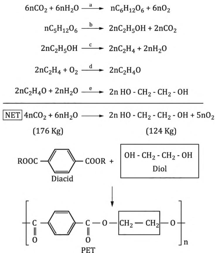
Терефталевая кислота — 8С; этиленгликоль — 2С; общее содержание биоуглерода составляет 20 % от общего углерода или общего органического углерода. Компонент кислоты — 68,75 %; компонент гликоль — 31,25 % от общей массы.
