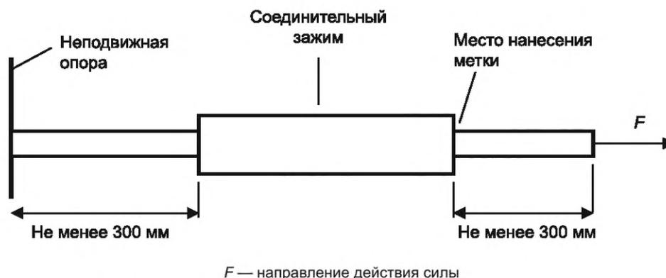
Рисунок 5.6 — Схема испытания соединительного зажима на прочность заделки
