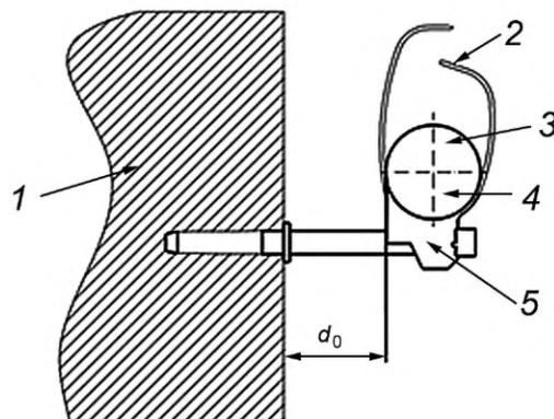
1 — стена здания; 2 — крепежный элемент; 3 — СИП; 4 — ложемент; 5 — корпус;
