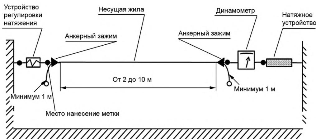
Рисунок 5.2 — Схема испытания анкерных зажимов на прочность
