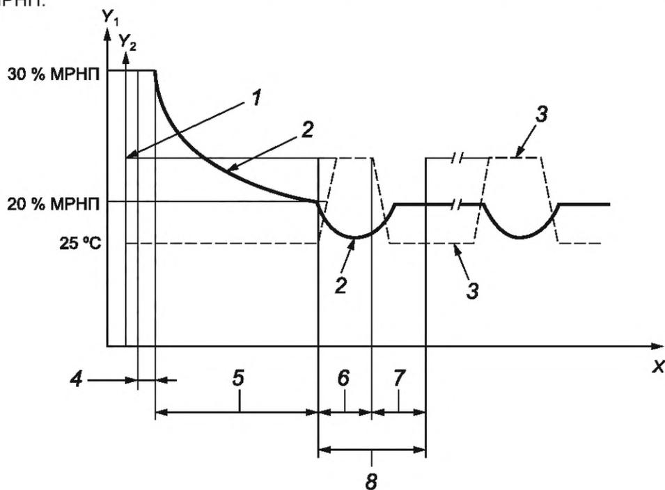
1 — нормальная рабочая температура, град; 2 — график изменения механической нагрузки; 3 — график изменения температуры жилы; 4 — 10 мин; 5 — 24 ч; 6 — 45 мин; 7 — 45 мин; 8 — основной цикл (90 мин);  $X$  — ось времени;  $Y_1$  — ось механической нагрузки;  $Y_2$  — ось температуры
