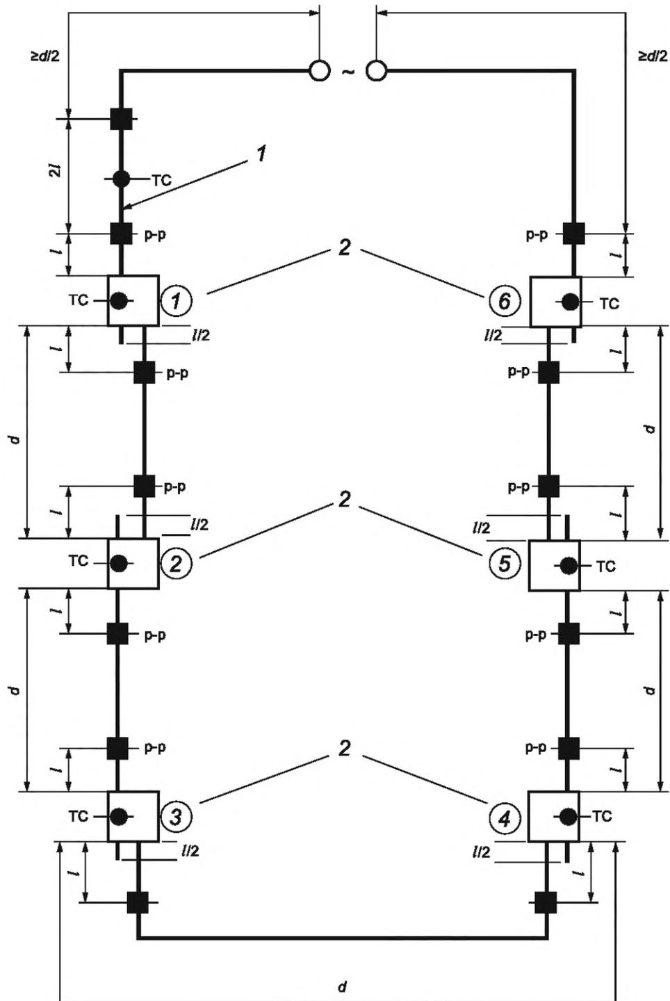
1 — контрольный провод, расположенный между выравнивателями; 2 — ОЗ  $\ell_a = \ell_b = \ell$  и  $\ell_r = 2\ell$ ;  $d$  — длина провода между зажимами;  $d \geq 80 \sqrt{A}$ , но не менее 500 мм;  $A$  — поперечное сечение проводника, мм<sup>2</sup>, остальные обозначения по таблице Б.1
