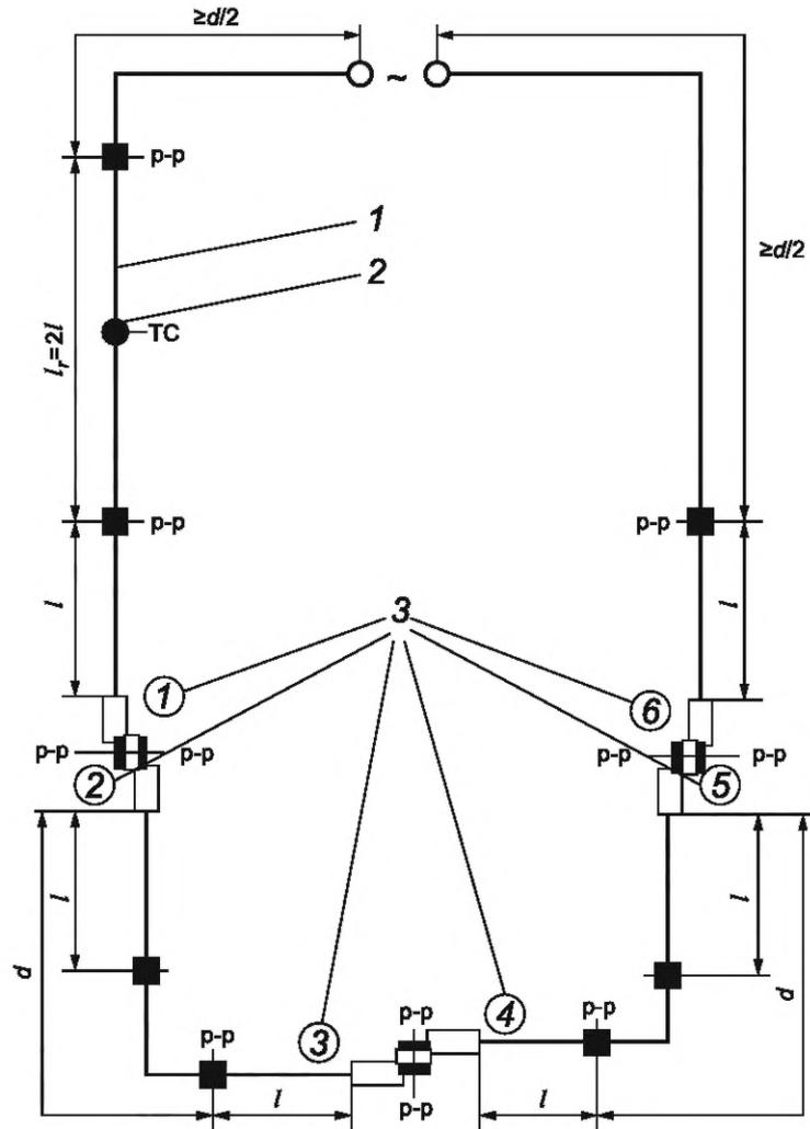
ТС — термопара; p.p — точка измерения разности потенциалов;  $l_a = l_b = l$  и  $l_f = 2l$  — расстояние между точкой измерения и корпусом зажима;  $A$  — сечение провода, мм<sup>2</sup>;  $d$  — длина жилы провода между двумя соединителями, мм:  $d \geq 80 \sqrt{A}$  или не менее 500 мм; 1 — контрольный провод, расположенный между выравнивателями; 2 — термопара в середине жилы провода; 3 — наконечники
