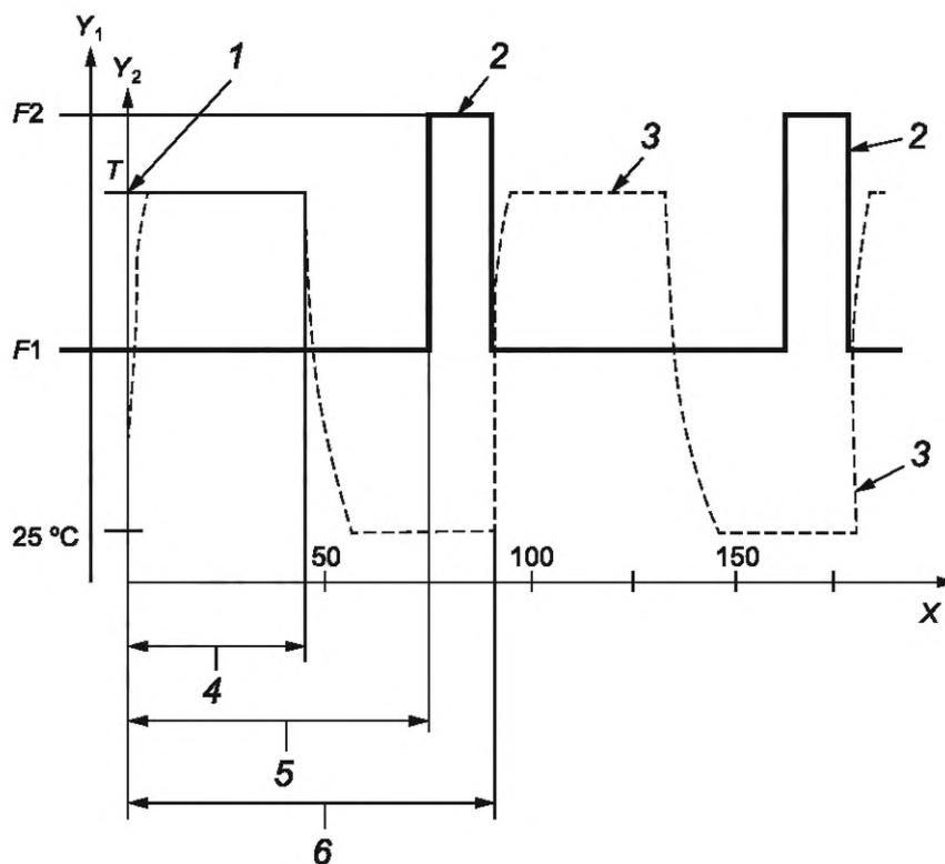
1 — нормальная рабочая температура; 2 — механический цикл; 3 — тепловой цикл; 4 — 45 мин; 5 — 75 мин;
