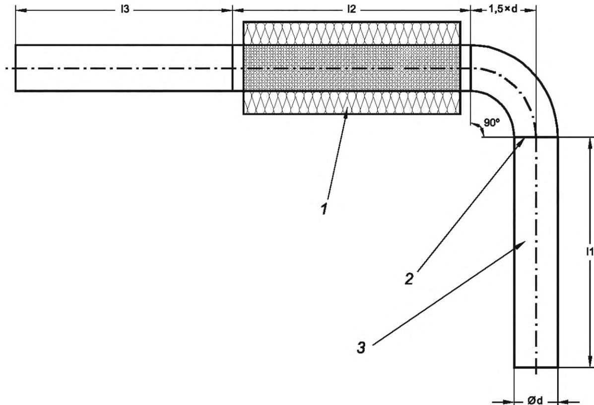
1 — глушитель (см. таблицу); 2 — соединение с коленом (не должно искажать поток воздуха, приводить к потерям давления и излучению дополнительного шума); 3 — труба с гладкими внутренними стенками;
