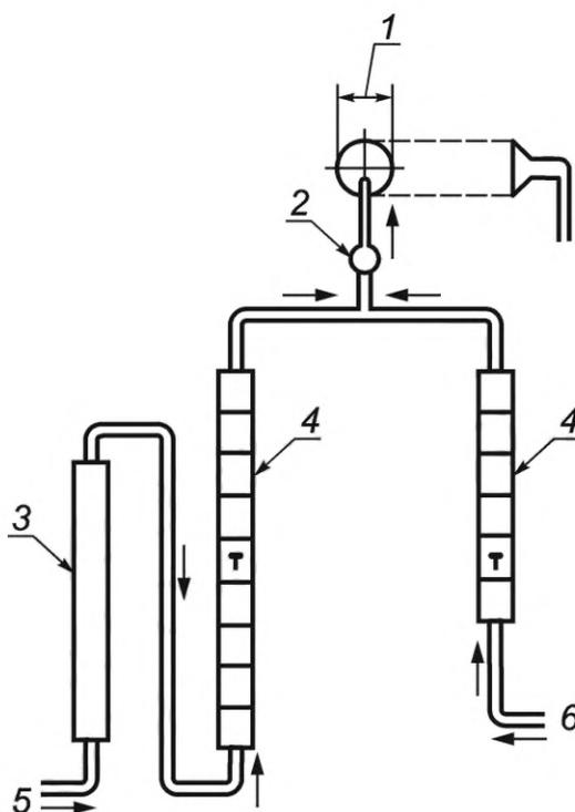
1 — стеклянная воронка диаметром 75 мм; 2 — колба для смешения; 3 — колонка для очистки воздуха;
