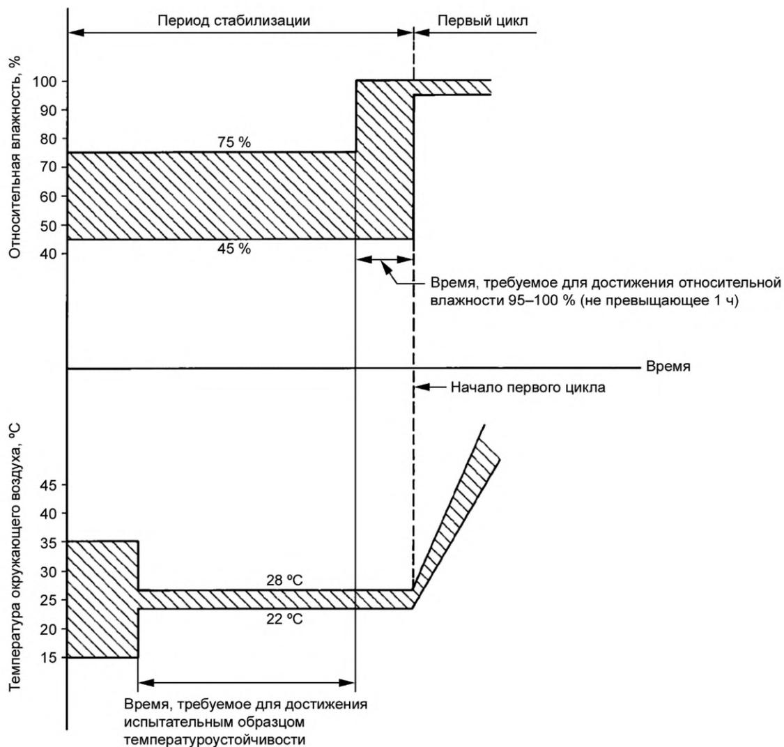
Рисунок 19 — Период стабилизации для испытаний на надежность (9.20.1.3)
