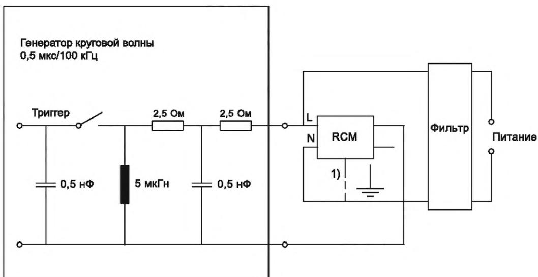
1) — Если RCM имеет заземляющий зажим, то он должен быть присоединен к нейтральному зажиму, если таковой имеется, и к любому фазовому выводу, если знак заземления нанесен на RCM, или в случае отсутствия такой возможности — к одному из фазных зажимов.
