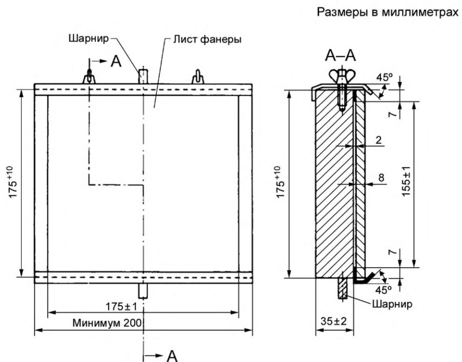
Рисунок 11 — Монтажное основание для испытания на механический удар (9.12.1)
