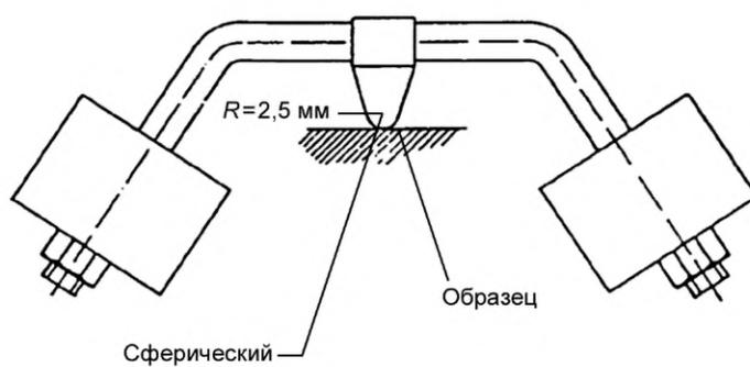
Рисунок 15 — Аппарат для испытания на твердость давлением шарика (9.13.2)
