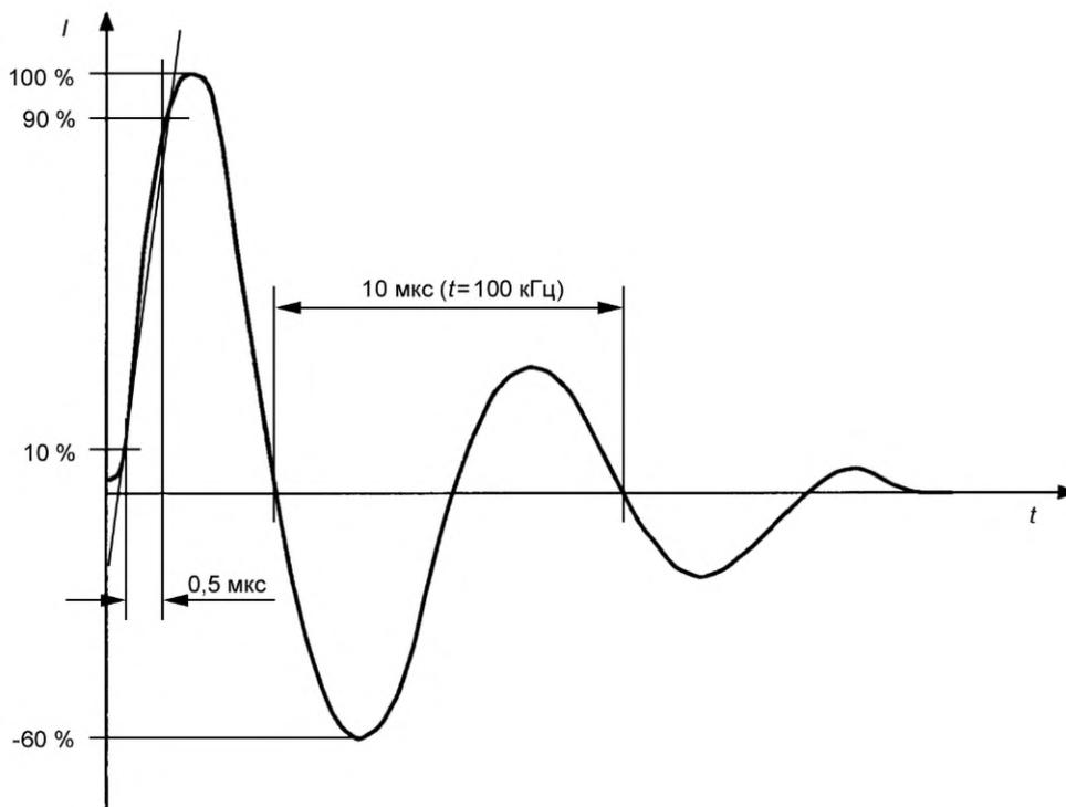
Рисунок 17 — Волнообразный импульс затухающего тока 0,5 мкс/100 кГц
