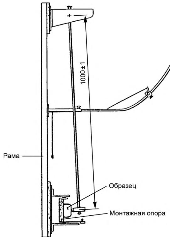
Рисунок 9 — Аппарат для испытания на механический удар (9.12.1)
