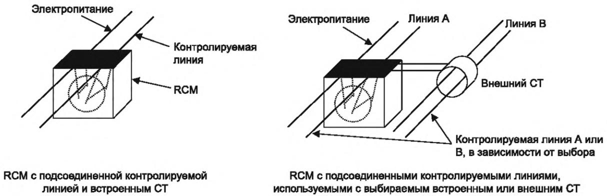
Рисунок 22b — RCMs с подсоединенными контролируемыми линиями
