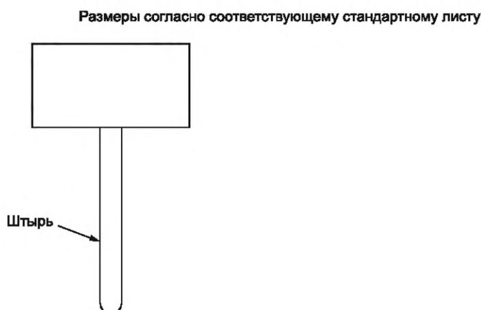
Масса должна быть равномерно расположена вокруг центральной (ых) линии (линий) штыря.
