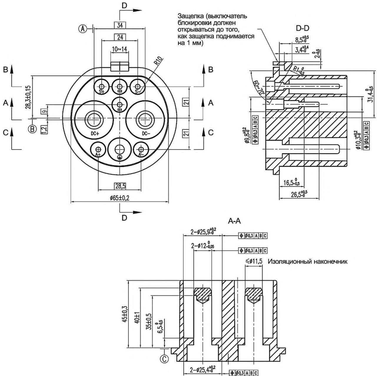
При размере  $\phi 65$  допускается зазор, после зазора максимальная размерная позиция (стандартизованная исходная база С) должна соответствовать требованиям допуска размеров.
